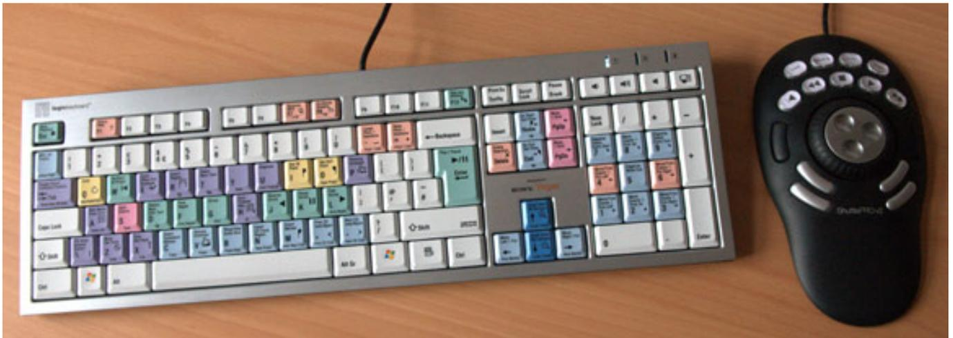
Als sinnvolle Ergänzung bietet sich einmal die Vegas-Tastatur von Logickeyboard an. Hier ist es nur wichtig wegen der Tastenbelegung im Betriebssystem das Tastaturprofil auf "Britisch Englisch" und nicht auf "US Englisch" einzustellen. Weiter ist der USB-Controller ShuttlePRO v2 von Contour Design empfehlenswert. Es ist zwar kein Vegas 10 Profil gespeichert aber ein bestehendes älteres Vegas Profil lässt sich leicht anpassen.
