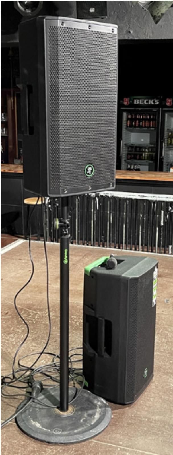
Nach Betätigung des Netzschalters sind die Boxen sofort betriebsbereit. Daher darf man davon ausgehen, dass kein DSP oder ähnliches Speaker-Management verbaut wurde. Diese würden bauartbedingt immer einige Sekunden für den Boot-Vorgang benötigen. Darüber hinaus fällt mir auf, dass die Thrash 212 Lautsprecher
