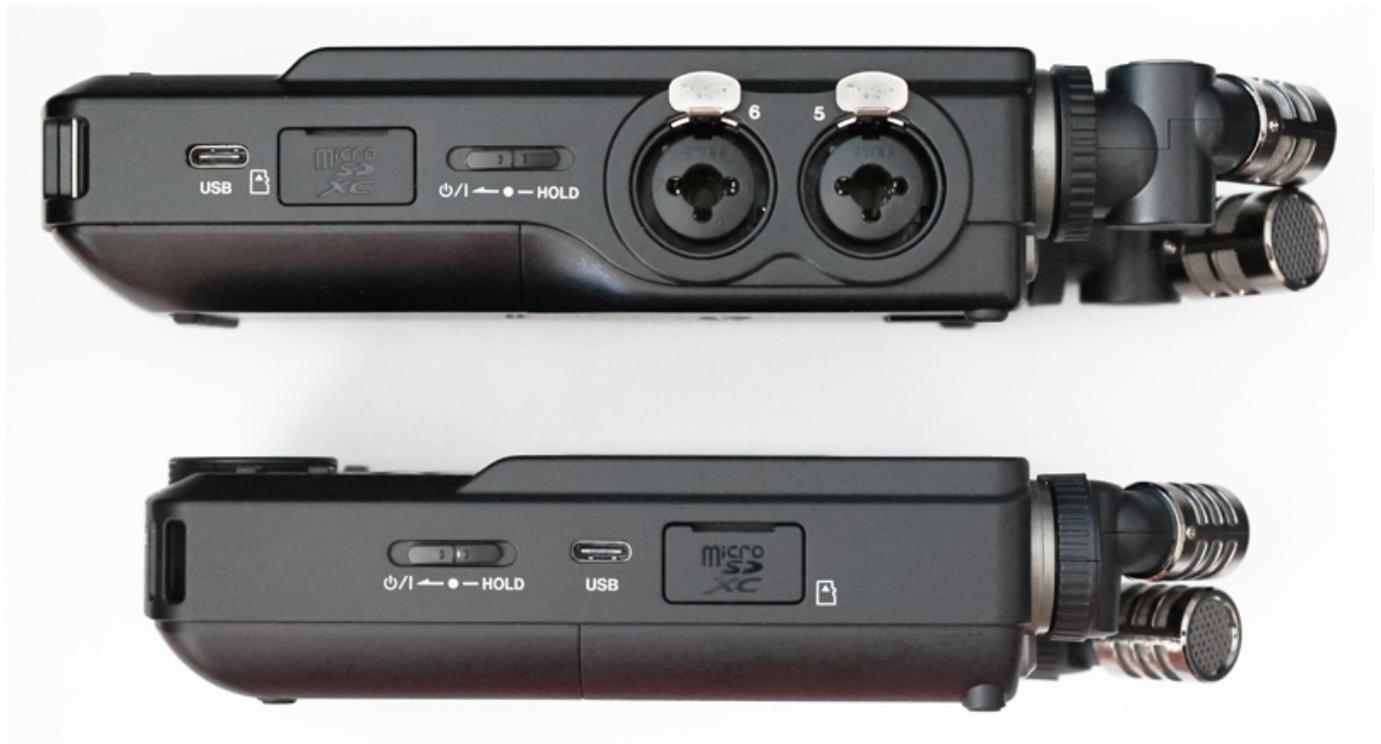
Die Mikrofoneingänge 1 - 2 des Portacapture X8 sind unsymmetrisch ausgelegt und eignen sich aufgrund der 3,5-mm-Klinkenbuchsen für Lavalier-Mikrofone, falls das mitgelieferte Mikrofonset nicht eingesetzt werden soll.
