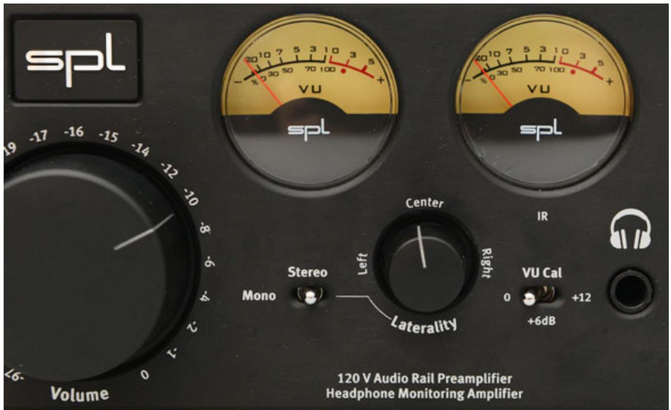
Der Phonitor 2 bietet ein Poti mit der Bezeichnung "Lateralität". Dahinter verbirgt sich die Möglichkeit der Anpassung des Pegels zwischen den beiden Stereokanälen. Der Regelbereich umfasst 4,5 dB und ist also entsprechend hoch aufgelöst, um ggf. vorhandene Unterschiede zwischen rechtem und linkem Ohr ausgleichen zu können. Diese Funktion wird mit dem Dreiwegeschalter neben dem Regler aktiviert, bzw. deaktiviert. Mit diesem Schalter kann man auch auf den Monobetrieb umschalten.
