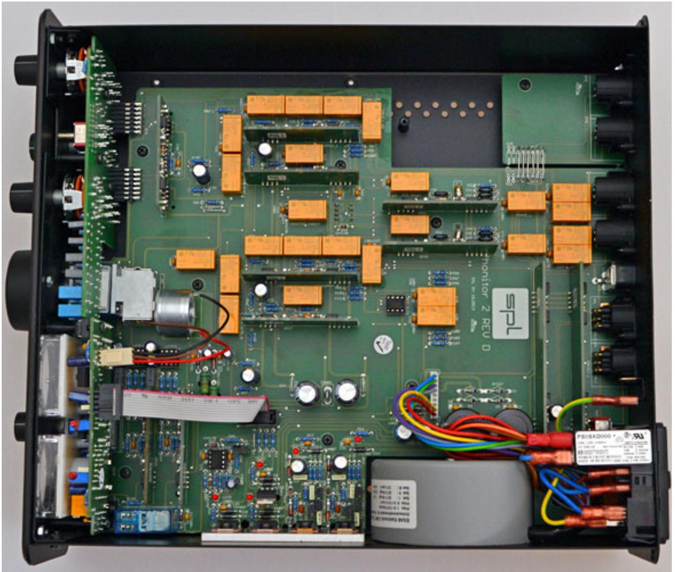
Im Gegensatz zum Vorgänger wird die Stereo/Mono-Umschaltfunktion, sowie das neue Ein-/Ausgangsrouting, über Relais geschaltet, was den Signalfluss im Gerät optimiert und man so das Übersprechverhalten verbessern konnte. Auch das verbesserte Platinen-Layout, was durch das neue Gehäuse möglich wurde, trägt zur Verbesserung des Übersprechens bei. Die beiden Audiosektionen für linken und rechten Kanal sind deutlich getrennt (s. Foto oben).
