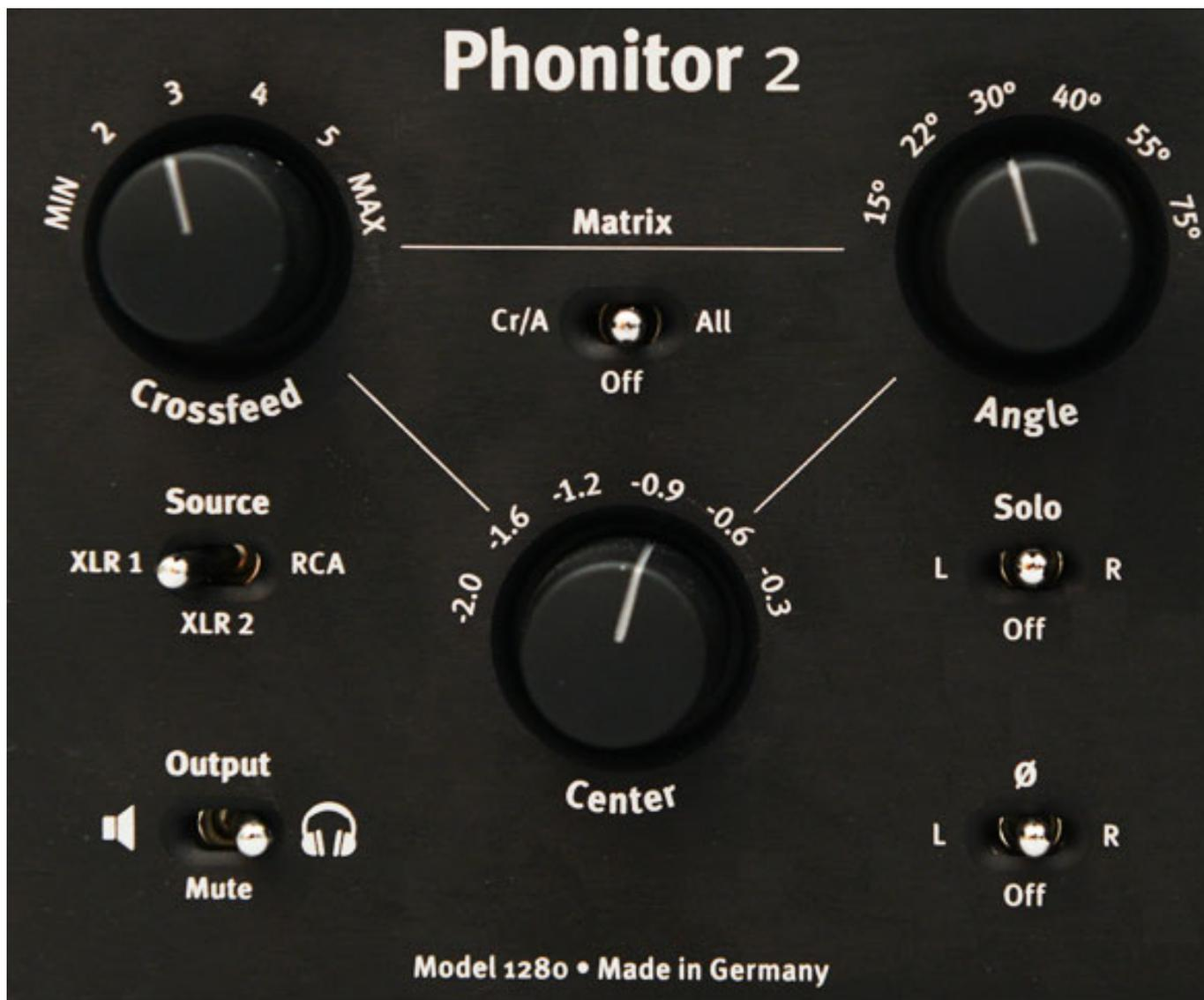
Auf der linken Geräteseite befinden sich neben dem Schalter für die Quellenwahl (XLR 1, XLR2, RCA) und dem Ausgang (XLR oder Kopfhörer) sowie dem Phasentausch (aus bzw. Tausch rechts oder links) noch drei Regler für die schon vom Phonitor bekannte Lautsprechersimulation.
