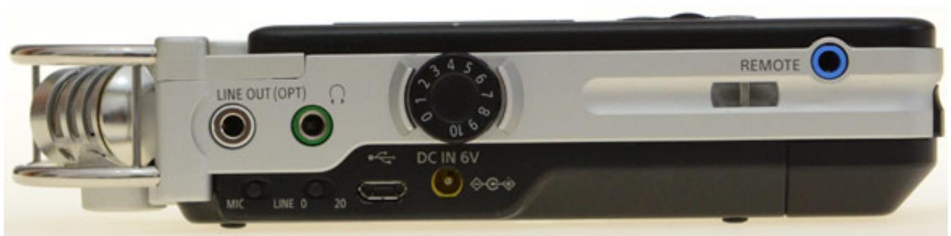
Komplettiert wird das Ganze von einem Einstellregler für den Ausgangspegel auf der einen Seite und einem Doppelregler (Pegel links/rechts) für die Anpassung des Eingangspegels. Zum Abhören ist auch ein kleiner Lautsprecher integriert, der für Kontrollzwecke gedacht ist.
