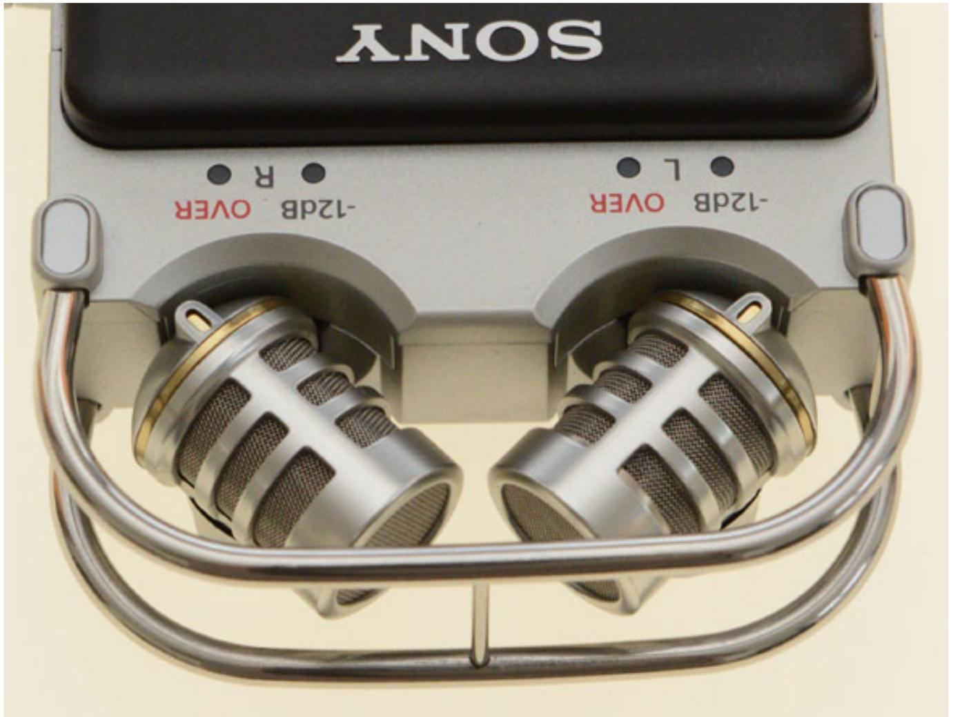
Der PCM-D100 verfügt über zwei eingebaute Mikrofone mit einem Membrandurchmesser von 15 mm. Die Mikrofone lassen sich in drei Positionen bringen und zwar einmal in einer Quasi-XY-Konfiguration (-90 Grad, s. Foto oben) für Laufzeitstereophonie, dann gerade und im 120 Grad Winkel nach außen. Beim Einsatz als XY-Stereomikrofon werden automatisch die Kanäle vertauscht, so dass Schallquellen von rechts oder links auch als solche geortet werden.
