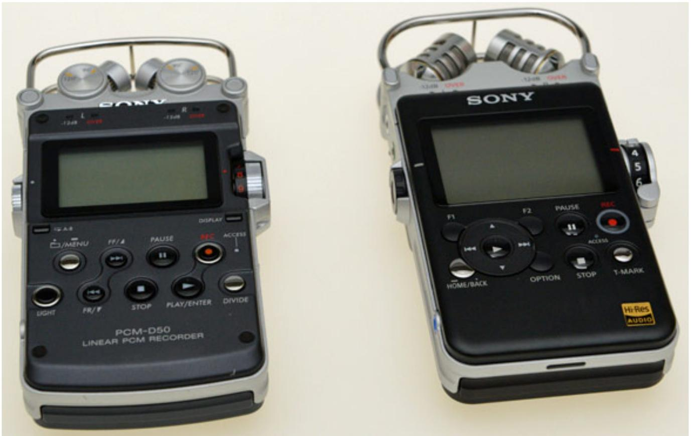
Bei der 0-Grad-Ausrichtung beider Mikrofone nach vorne, arbeiten die Mikrofone quasi als Mini-AB-Stereo-Mikrofon. Das heißt, dass die mögliche Stereobasisbreite durch die geringen Laufzeitdifferenzen bewusst eingeschränkt ist. Ideal z. B. für Interviews, bei dem die Gesprächspartner eng beieinander stehen.
