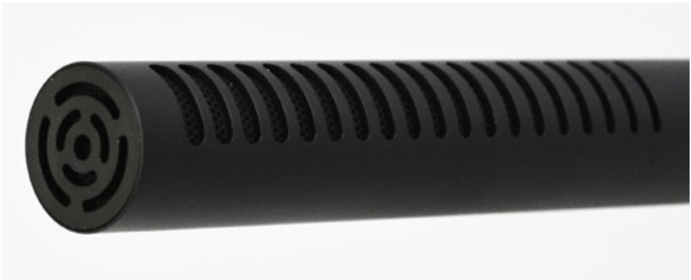
Das ECM-778 hat einen Durchmesser von 20 mm und eine Länge von 176 mm (Gewicht 102 Gramm) und das Aluminium-Metallgehäuse ist schwarz lackiert. Das ECM-678 ist übrigens mit 250 mm deutlich länger. Als Kapsel wird eine Elektretkapsel eingesetzt. Betrieben wird das Mikrofon mit einer Phantomspeisung mit einem Betriebsbereich von 44 bis 52 Volt, wobei der Betriebsstrom maximal bei moderaten 4 mA liegt.
