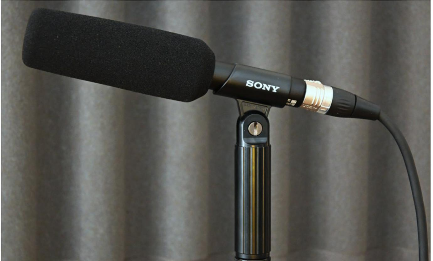
Sony bietet in der ECM-Serie eine ganze Reihe von Elektret-Kondensator-Shotgun-Mikrofone an wie das ECM-678, das kürzere ECM-673 oder das Stereo-Shotgun-Mikrofon ECM-680S. Im Juni 2025 stellte Sony nun das ECM-778 vor, welches wir schon einige Wochen vor der offiziellen Präsentation ausführlich testen konnten.
