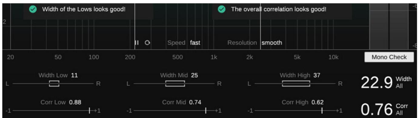
Man kann auch ein "Mono Check" durchführen - also ein Überprüfen der Korrelation. Auch dieser wird als Text ausgegeben. Unten wird auch die Stereobasisbreite sowie der Korrelationsgrad ausgegeben (s. Abb. oben) und das auch einzeln für die drei
