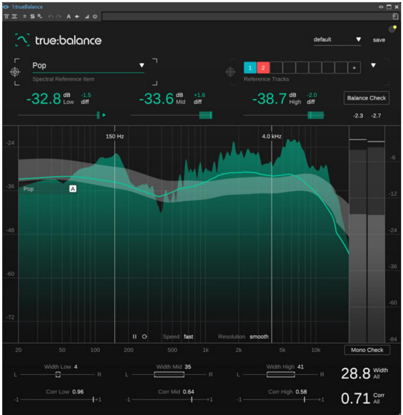
Mit true:balance wird richtige Frequenzwichtung kontrolliert. Im Plug-In wird das Stereo-Eingangssignal analysiert und in einer Grafik Spitzen- und Mittelwert angezeigt, sowie ein weitere Graf, der die Frequenzwichtung einer Referenz anzeigt. Der gesamte Übertragungsbereich wird in den drei Frequenzbereichen Low, Mid und High aufgeteilt. Die Grenzen lassen sich mit der Maus verändern. Angezeigt
