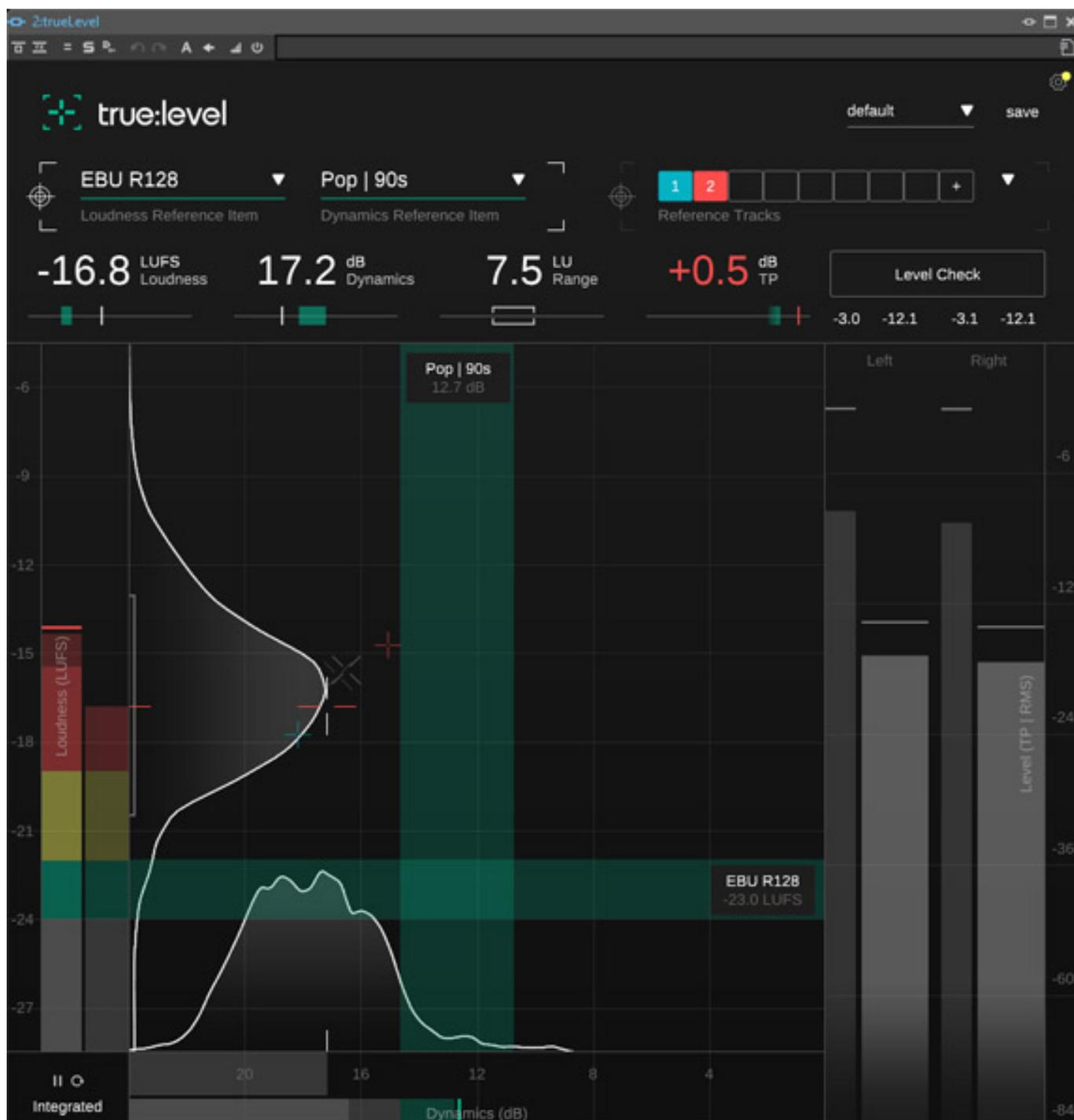
Und nun zum true:level Plug-In, das den Pegel im Verhältnis zu einer eingestellten Referenz analysiert. In der Grafik wird auf zwei Achsen die Lautheit und Dynamik dargestellt. Der Lautheitsbereich sowie die aktuelle Lautheit werden links neben dem Grafen ausgegeben. Rechts sind zwei Meter für die beiden Pegel der Stereokanäle, die sowohl RMS- als auch True-Peak-Pegel anzeigen. Unten sind
