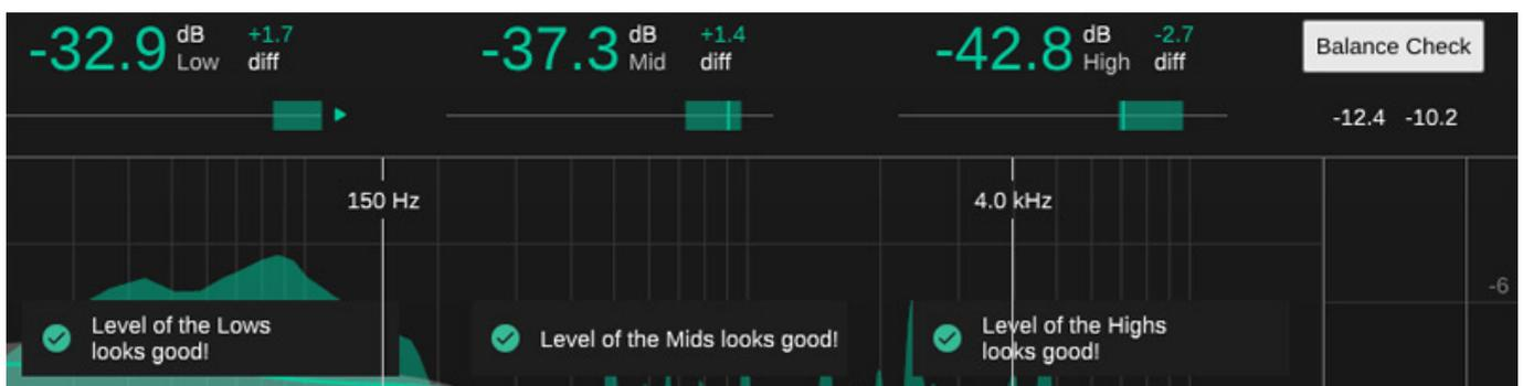
Zu guter Letzt gibt es noch einen virtuellen Schalter, um eine Balance Check anzuzeigen. Hier werden Empfehlungen (s. Abb. oben) für den Pegel der drei Frequenzbereiche ausgegeben.
