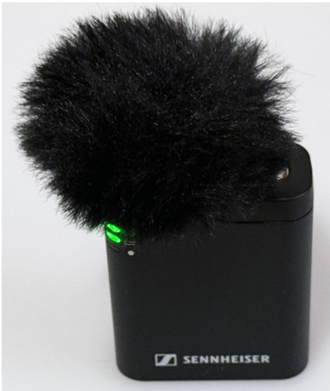
Der mitgelieferte Windschutz wird auf das Mikrofon aufgesetzt und durch Drehen arretiert.
