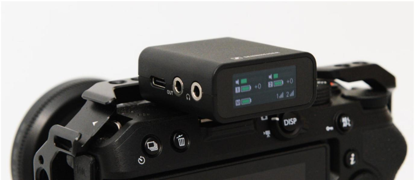
Über den mitgelieferten Blitzschuh-Adapter ermöglicht einen Betrieb auf einer Kamera (hier eine Nikon Z30 als Beispiel).
