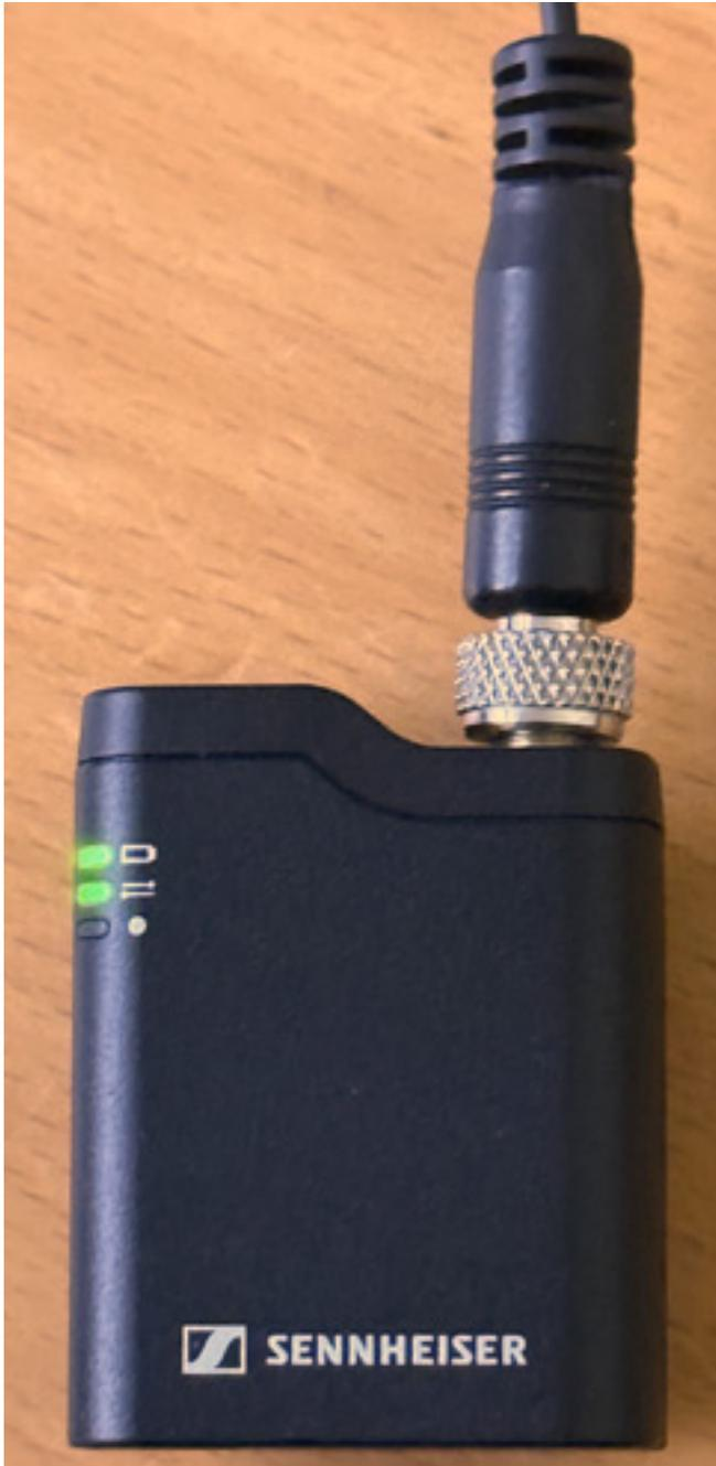
Dank der 3,5-mm-TRS-Klinkenbuchse lässt sich auch ein externes Mikrofon anschließen. Hier sieht man im Foto im Vergleich mit dem Miniklinkenstecker auch deutlich wie klein der Sender ist.
