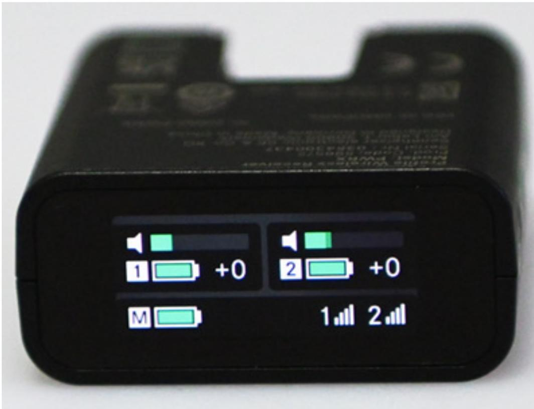
Der Empfänger ist mit einer Größe von 45 x 42 x 19 mm und einem Gewicht von 30 Gramm ebenfalls extrem kompakt und leicht. Er verfügt über ein OLED-Display und einen 350 mAh Akku mit einer Betriebszeit von ca. sieben Stunde und einer Vollladezeit von zwei Stunden. Der Profile-Wireless-Empfänger besitzt auch einen integrierten Kopfhörerverstärker. Hier lassen sich Kopfhörer mit mindestens 32 Ohm Impedanz anschließen. Die Ausgangsleistung beträgt 25 mW.
