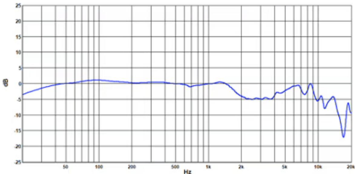
Im Vergleich sieht man im Bassbereich, dass der Verlauf bei den Velour-Polstern im Bassbereich bei ca. 90 Hz gegenüber der Referenz bei 1 kHz ca. 5 dB mehr Pegel aufweist. Der Übertragungsbereich mit Stoff ist deutlich linearer. Auch im Bereich ab ca. 3 kHz ist etwas mehr Pegel vorhanden als bei den Stoff-Ohrpolstern. Daher spricht Sennheiser bei den Velour-Polstern von einer Optimierung für den Einsatz im Producing-Bereich und bei den Stoffpolstern von einer Optimierung für das Mixing.
