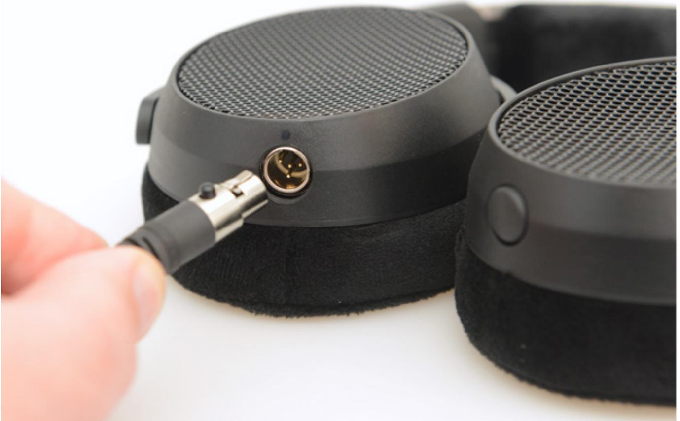
Eine weitere erfreuliche Besonderheit ist die, dass am Kopfhörer Mini-XLR-Buchsen in beiden Ohrmuscheln verbaut sind. Man kann also den Anschluss rechts oder links nutzen und den nicht benutzen durch einen Gummipfropfen abdecken.
