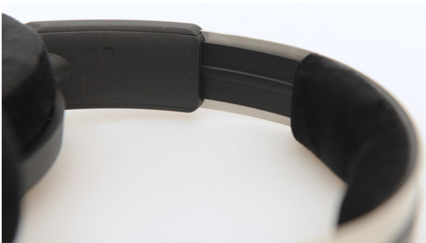
Der Kopfbügel lässt sich auf jeder Seite um ca. 37 Millimeter verschieben, also ca. 75 mm insgesamt. Der Bügelauszug ist gerastert und auf der Oberseite ist auch eine Skala aufgebracht, damit man den Auszug auf beiden Seiten gleich einstellen kann.
