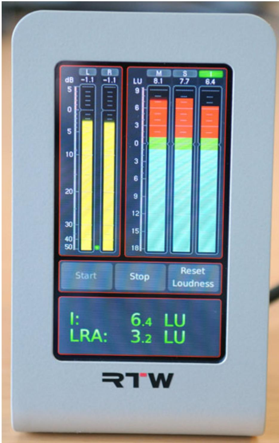
Es gibt zurzeit nur eine Lizenz und das ist die Upgrade-Lizenz von TM3 auf TM3-6CH, da das TM3 schon umfassend mit Instrumenten und Messverfahren ausgestattet ist. Es stehen Peak, True-Peak, Korrelationsgrad- und auch Loudness-Messungen zur Anwahl bereit. Die Loudness-Messung, bzw. Anzeige erfolgt nach den Standards EBU R128, ITU-R BS.1770-2/1771, ATSC A/85, ARIB oder anwenderspezifiziert. Es stehen auch Loudness-Range (LRA) und SPL-Anzeige bereit.
