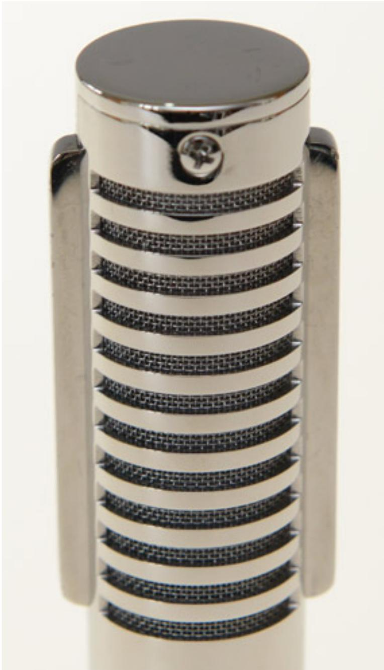
Mit dem R-121 Live gibt es auch eine spezielle Variante für den Bühnenbetrieb, welche sich durch eine besondere Robustheit auszeichnet. Äußerlich ist diese Version lediglich an dem roten Royer-Logo zu erkennen. Beim R-121 Live wurde das Bänchenelement von 2,5 auf 4 Mikrometer erhöht, was das Mikrofon unempfindlicher macht. Akustisch wird dadurch der Höhenanteil gegenüber der Standardversion etwas bedämpft, was für den Live-Einsatz durchaus nicht als Nachteil zu sehen ist.
