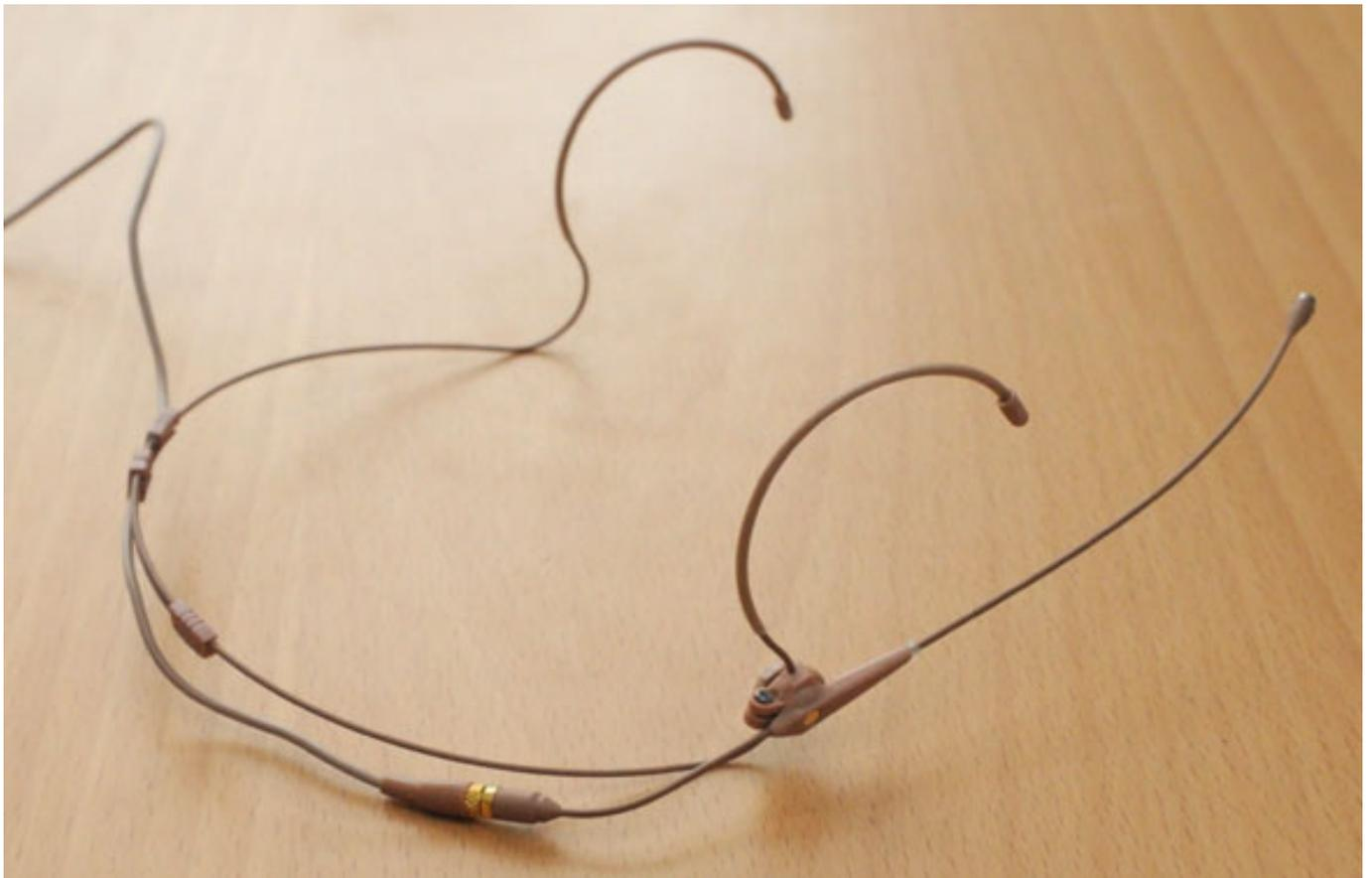
Das Drahtgestell ist in gewissen Grenzen biegsam. Die Breite des Nackenbügels lässt sich durch Verschieben des Bügels anpassen. Weiter ist die Neigung des Mikrofonauslegers nach oben oder unten einstellbar.
