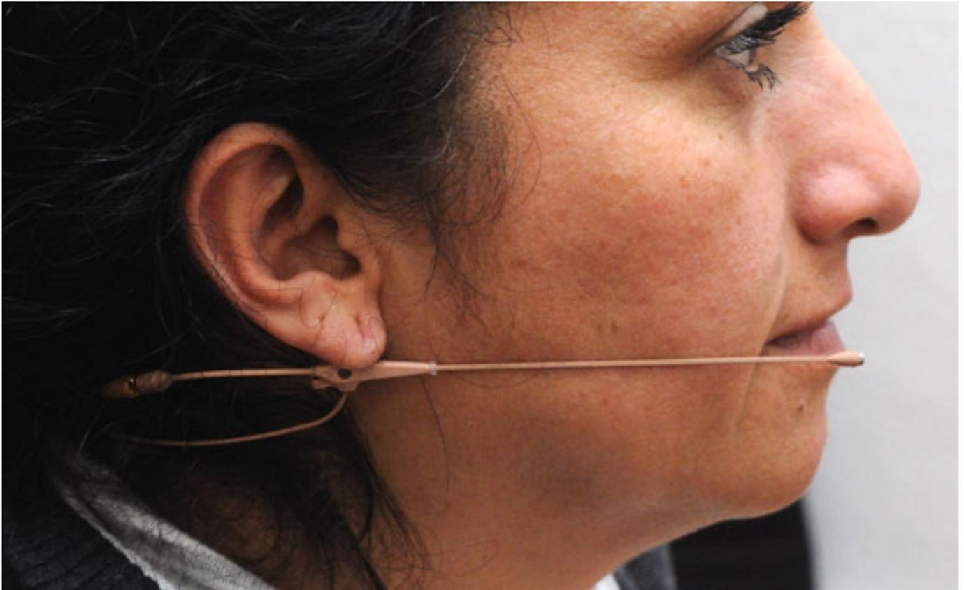
Auch die Länge des Auslegers ist durch Drehen des selbigen um einige Zentimeter nach vorn und hinten verschiebbar, um so die optimale Position für das Einsprechen einstellen zu können. Weiter lässt sich mit dem beiliegendem Werkzeug der Ausleger mit dem Mikrofon auch auf die linke Seite des Bügels montieren.
