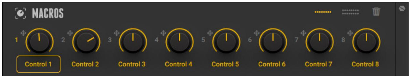
Mit der Macros-Komponente lassen sich bis zu acht einzelne Parameter auf einen von 16 Regler zuordnen. Die Darstellung lässt sich umschalten zwischen acht (wie in unserem Beispiel) oder 16 Reglern. Die Zuordnung erfolgt einfach durch Drag-and-Drop der Parameter auf die MACROS-Regler.
