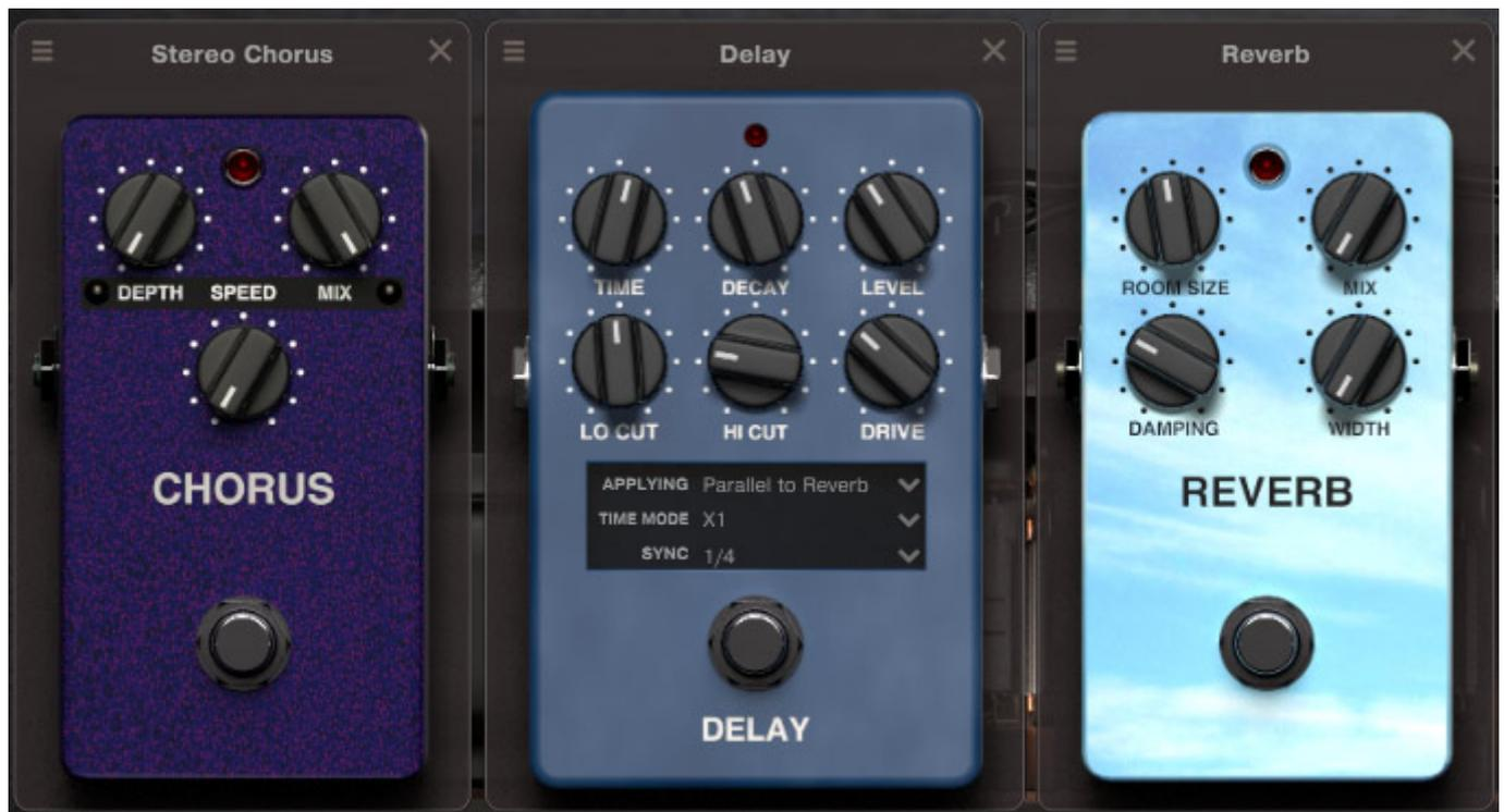
Als weitere Effekte gibt es ein Chorus, eine Delay mit Hoch/Tiefpass-Filter im Effektweg. bei dem man über unterschiedliche Zeitfaktoren auch Stereo-Ping-Pong-Effekte erzielen kann, sowie ein Reverb.
