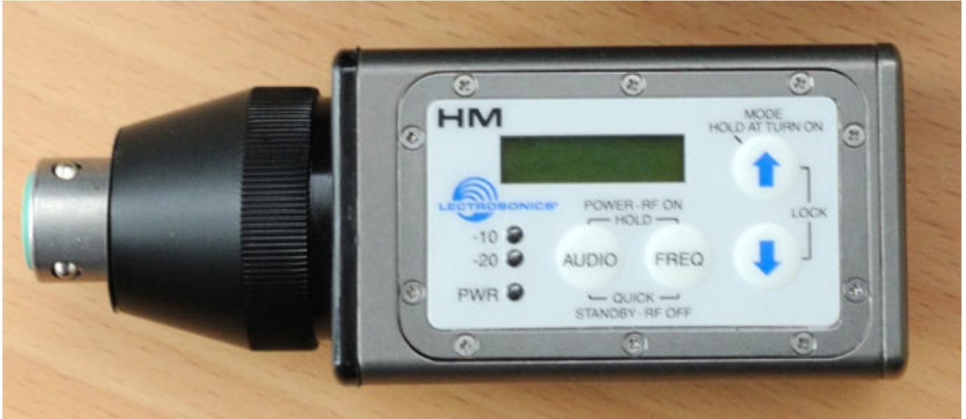
Mit dem Lectrosonics HM/E01 (s. Foto oben) wird ein Aufstecksender mit XLR-Buchse angeboten, der mit zwei AA-Zellen betrieben wird. Auch er bietet 256 Frequenzen im 100-kHz-Raster und in der Europaversion eine Sendeleistung von 50 mW. Die zuschaltbare Phantomspeisespannung lässt sich auf 5, 18 oder 48 Volt umschalten. Der Aufstecksender lässt sich auch als Messsender einsetzen.
