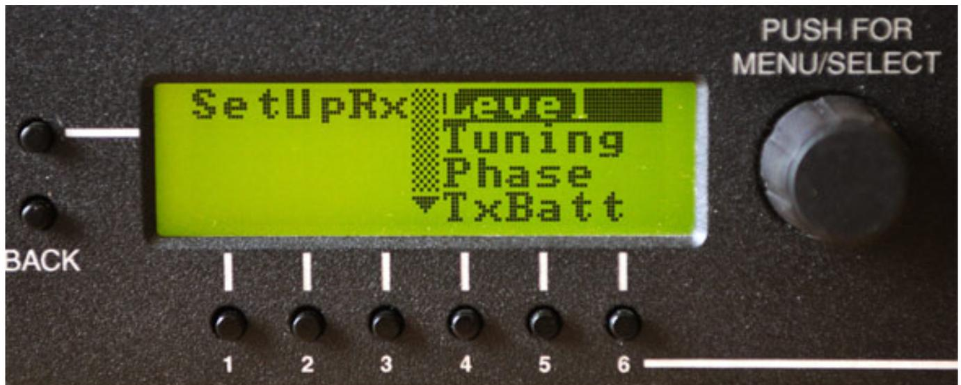
Für die Auswahl der Parameter eines bestimmten Empfängermoduls sind sechs Funktionstasten unter dem hintergrundbeleuchteten LC-Display vorhanden. Weiter gibt es noch eine Taste "Back" für den Wechsel in eine höhere Menüebene und einen weiteren Funktionstaster, z. B. für die Selektion der Auswahl eines bestimmten Parameters.
