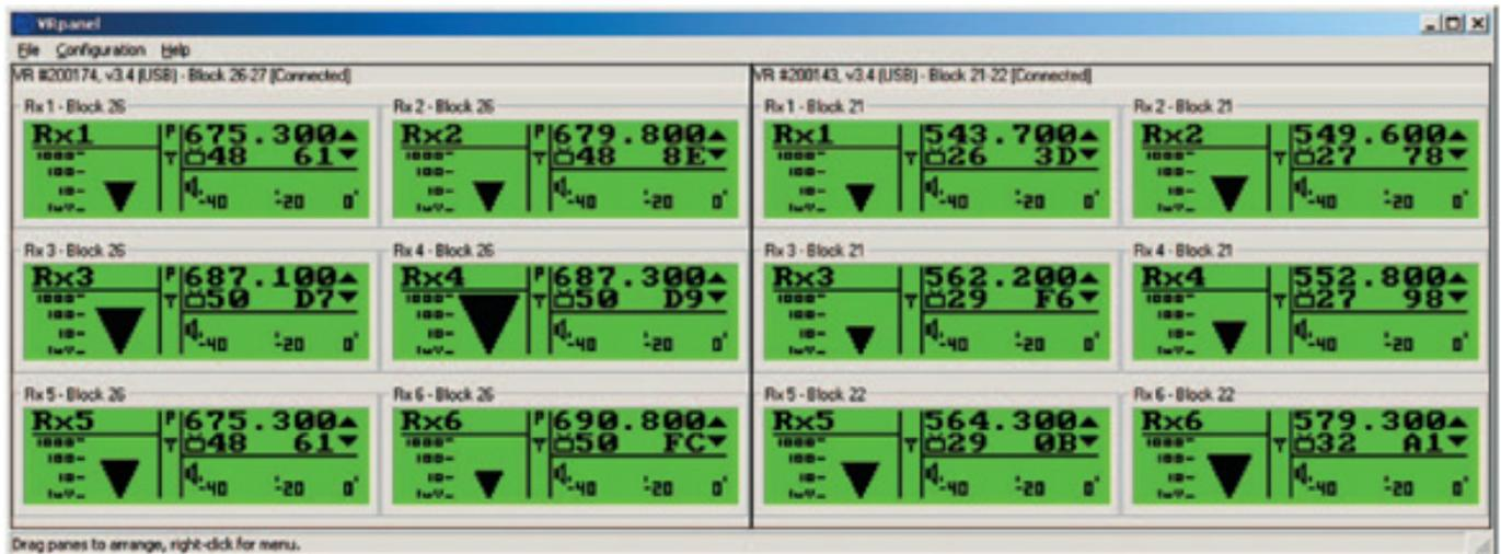
Über die frei verfügbare LecNet2-Software von Lectrosonics lassen sich die Venue-Empfänger auch konfigurieren (s. Abb. oben) und monitoren. Die Verbindung zum Empfänger-Rack erfolgt über RS-232 oder USB. Die Software läuft unter Window 2000, XP, Vista und Windows 7.
