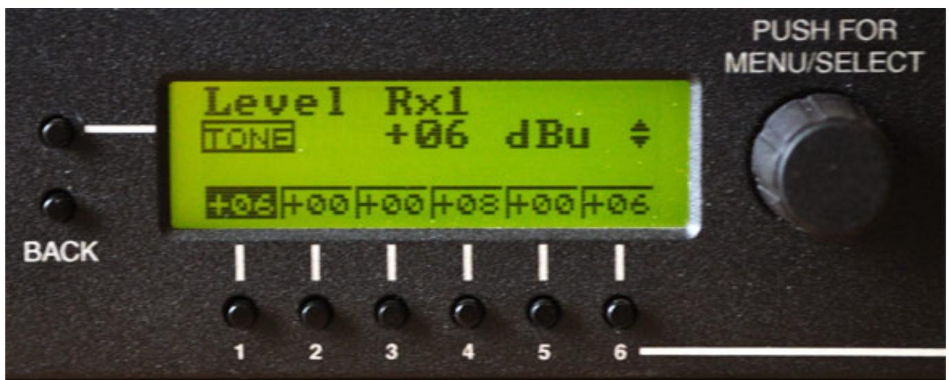
Eine Status-Seite bietet Überblick über den Feldstärke und Audiopegel aller Module und eine weitere Seite gibt den Status eines bestimmten ausgewählten Empfängermodul inklusive Frequenz dar. Der Venue-Empfänger verfügt auch über einen integrierte Band-Scan-Funktion, wobei sich das Ergebnis auch auf dem LC-Display ohne angeschlossenen PC darstellen lässt.
