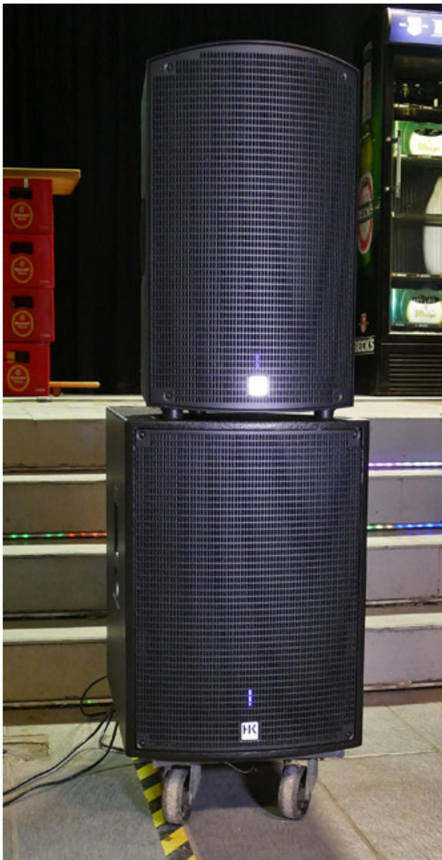
Das geht allerdings zu Lasten der maximalen Lautstärke, für deren Test ich das Stack in einen Live-Club verfrachte. Das Verhältnis ein SONAR-Top auf einen SONAR-Bass passt Indoor sehr gut. Die verbauten Limiter arbeiten lange unauffällig, bis zu exzessive Eingangspegel deutlich reduziert werden.
