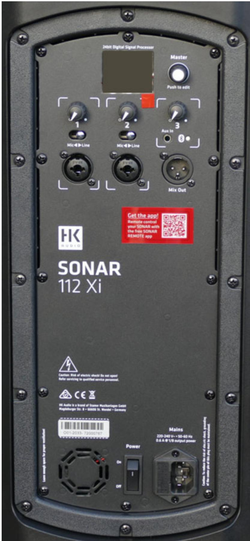
Kernstück der Box ist das Aktivmodul samt User-DSP. Neben der obligatorischen Kombination von Kaltgeräteeingangs- und Netzschalter verfügt das Modul über drei Eingänge und einer Mix Out XLR-Buchse. Ein 3-in-1-Minimixer, bei dem sich die Kombibuchsen-Eingänge 1 und 2 sowohl mit Line- als auch mit Mikrofonsignalen beschicken lassen. Kanal 3 ist für den analogen Anschluss eines Zuspielers via Mini-Klinkenbuchse gedacht. Alternativ lässt sich dieser Eingang auch mit einem Bluetooth-Stream versorgen.
