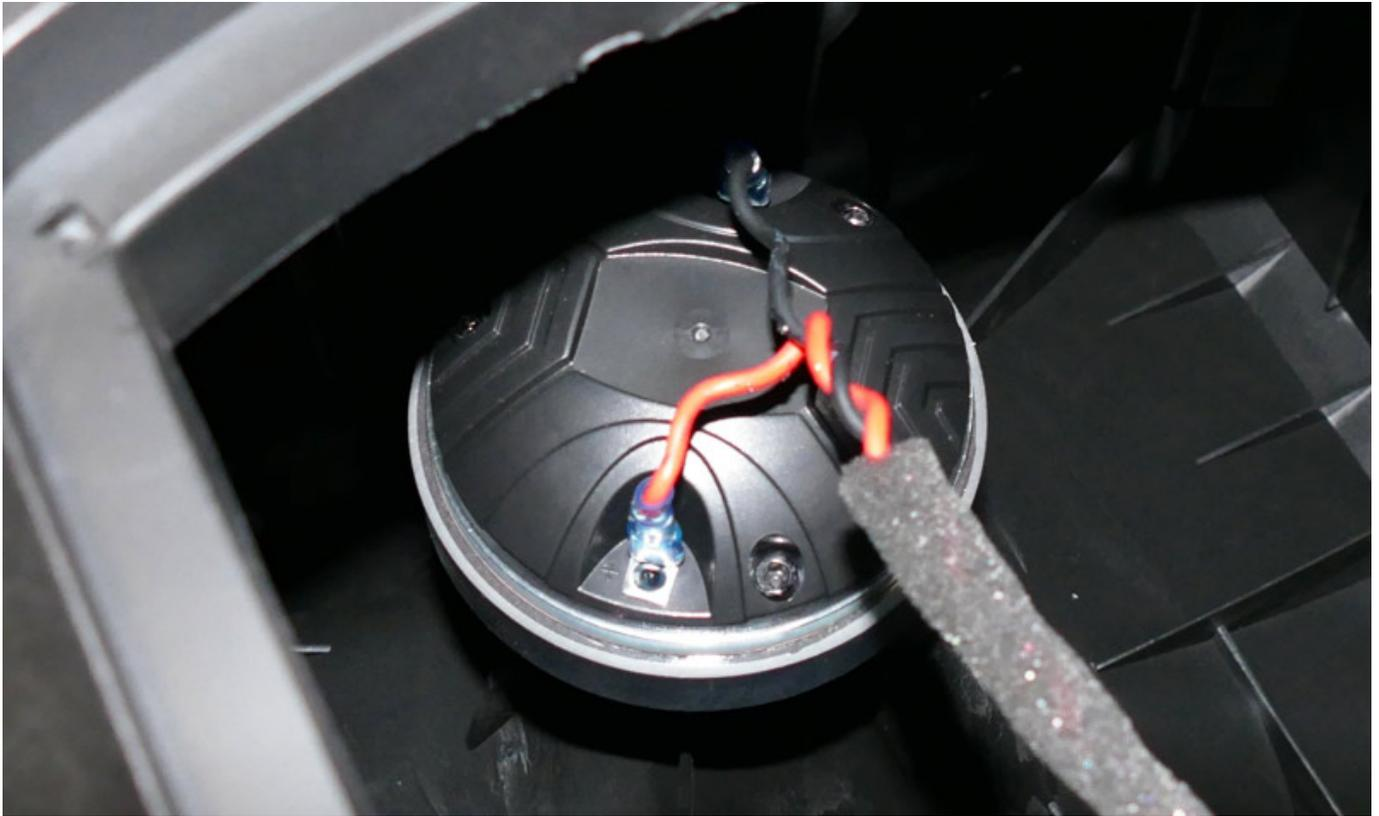
Beide Treiber sind mit Ferrit-Magneten ausgestattet, der 12-Zoll-Tieftöner ist ein einfaches Press-Chassis, was bei dem moderaten Preis zu erwarten war. Das Aktivmodul sitzt in einem geschlossenen Gehäuse und ist gut verarbeitet.
