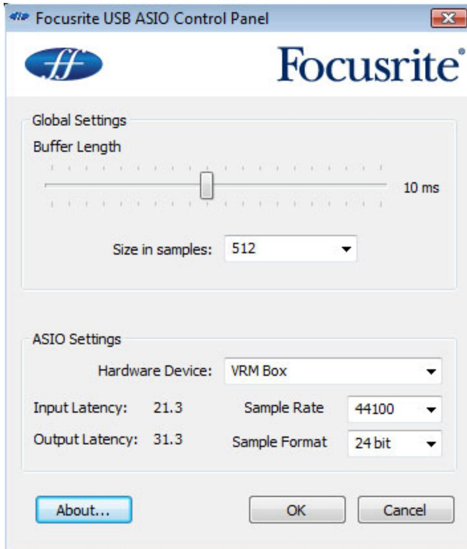
Die Latenz lässt sich über das Control Panel (s. Abb. oben) einstellen und steht per default auf 512 Samples (@ 44,1 kHz). Aber auch bei deutlich kürzeren Latenzen gab es bei unserem Test keine Probleme. Die kleinste Einstellung sind 64 und die größte 1024 Samples.
