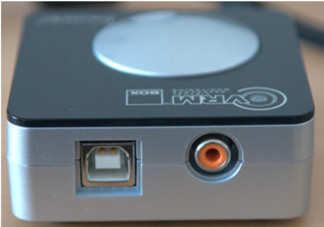
Das System besteht aus der VRM-Hardware-Box (68 x 68 x 25 mm) mit USB-2.0-Anschluss und Kopfhörerausgang (6,3 mm Stereo-Klinkenstecker). Der Kopfhörerausgang hat eine Anschlußimpedanz von kleiner 10 Ohm und die Maximalausgangsspannung beträgt bei 50 Ohm 30 mV und bei 150 Ohm 15 mV. Den Klirrfaktor gibt der Hersteller mit -100 dB (-1 dBFS, 150 Ohm Last, 20 Hz ... 22 kHz) und den Rauschabstand mit größer 105 dB an.
