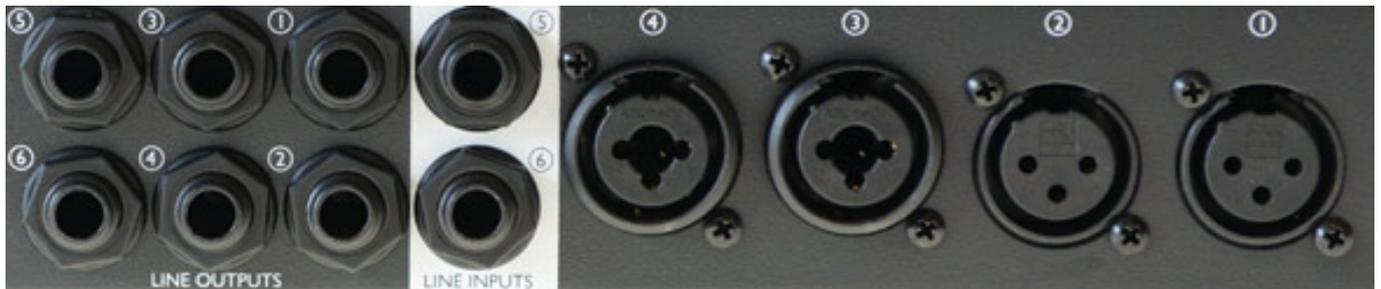
Neben den sechs Eingängen befinden die sechs Line-Ausgänge ebenfalls in Form von 6,3-mm-Stereo-Klinkenbuchsen (sym./unsym.). Maximaler Ausgangspegel beträgt 15,7 dBu (0 dBFS).
