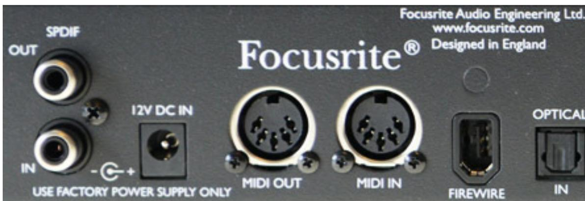
Des Weiteren sind ganz links auf der Rückseite noch digitale Schnittstellen zu finden und zwar SPDIF Ein- und Ausgang sowie ein (optischer) TOSLINK-Eingang für den Anschluss von Quellen mit ADAT-kompatiblen Digitalschnittstellen (8 Audiokanäle @ 44,1/48 kHz, bzw. 4 @ 88,2/96 kHz Abtastrate). Der Eingang lässt mit der Software sich auch bei Bedarf auf optischen SPDIF-Betrieb (zwei Audiokanäle) umschalten. Auch eine MIDI-Schnittstelle (Ein-/Ausgang) darf natürlich ebenfalls nicht fehlen.
