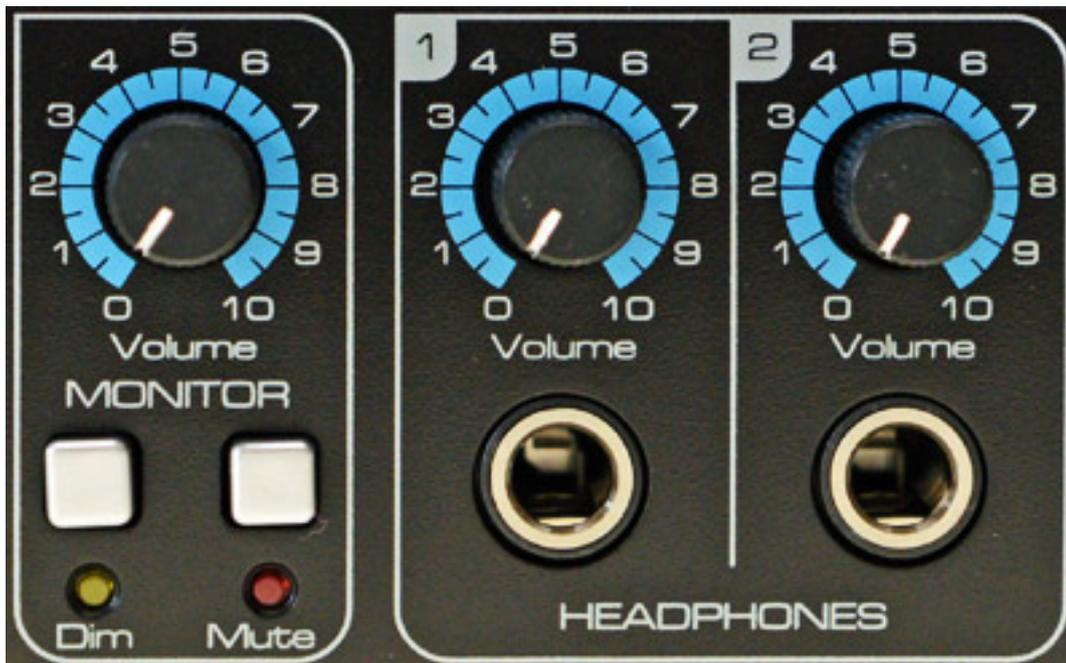
Komplettiert wird die Frontplattenbedienung von den beiden individuell regelbaren Kopfhörerausgängen ganz rechts auf der Frontplatte, die den Ausgängen 3/4, bzw. 5/6 zugeordnet sind.
