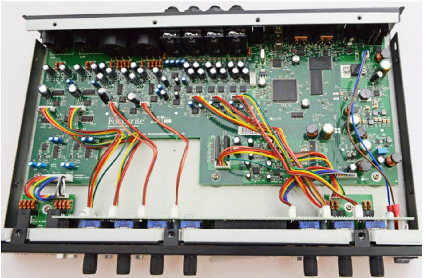
Ein Blick in das Gerät zeigt, dass aktuelle Operationsverstärker von JRC sowie u. a. drei Stereo-A/D-D/A-Wandler von Cirrus Logic Typ CS 4272 verbaut sind. Abtastraten sind zwischen 44,1 und 96 kHz, bei einer Wortbreite von 24 Bit, möglich.
