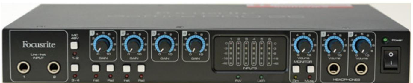
Das Saffire PRO 26 verfügt über 18 Ein- und acht Ausgängen. Auf der Vorderseite befinden sich zwei Instrumenteneingänge (6,3-mm-Klinenstecker, sym./unsym. beschaltbar, max. Pegel 8 dBu ohne Pad) sowie die beiden Kopfhörerausgänge (6,3-mm-Stereoklinenbuchse, 13 mW @ 47 Ohm bzw. 1,7 mW @ 300 Ohm, Frequenzgang 10 Hz ... 200 kHz). Alle anderen Ausgänge sind auf der Geräterückseite zu finden. Neben der Kopfhörersektion befindet sich der Ein/Ausschalter.
