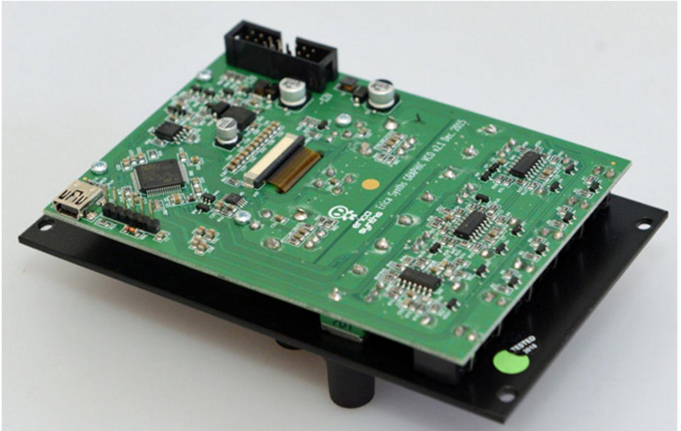
Das Modul hat eine Einbautiefe von lediglich 25 mm und passt daher in jedes Rack. Auf der Rückseite befindet sich auch eine USB-Schnittstelle. Sie dient einmal zum Updaten der Firmware aber in Zukunft soll auch ein Editor für Wavetables verfügbar sein. Der USB-Anschluss dient dann auch zum downloaden der erstellten oder modifizierten Wavetables.
