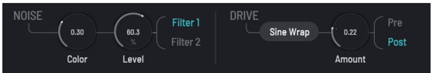
Unter dem Oszillator 2 und 3 ist noch ein Rauschgenerator zu finden, dessen Färbung und Pegel und Filteraufschaltung sich einstellen lässt. Hier ist auch ein Verzerrungs/Clipping-Modul, so möchte ich das mal nennen, vorhanden, dass sich über Pre/Post vor oder nach den Filtern im Signalfluss positionieren lässt. Es sind
