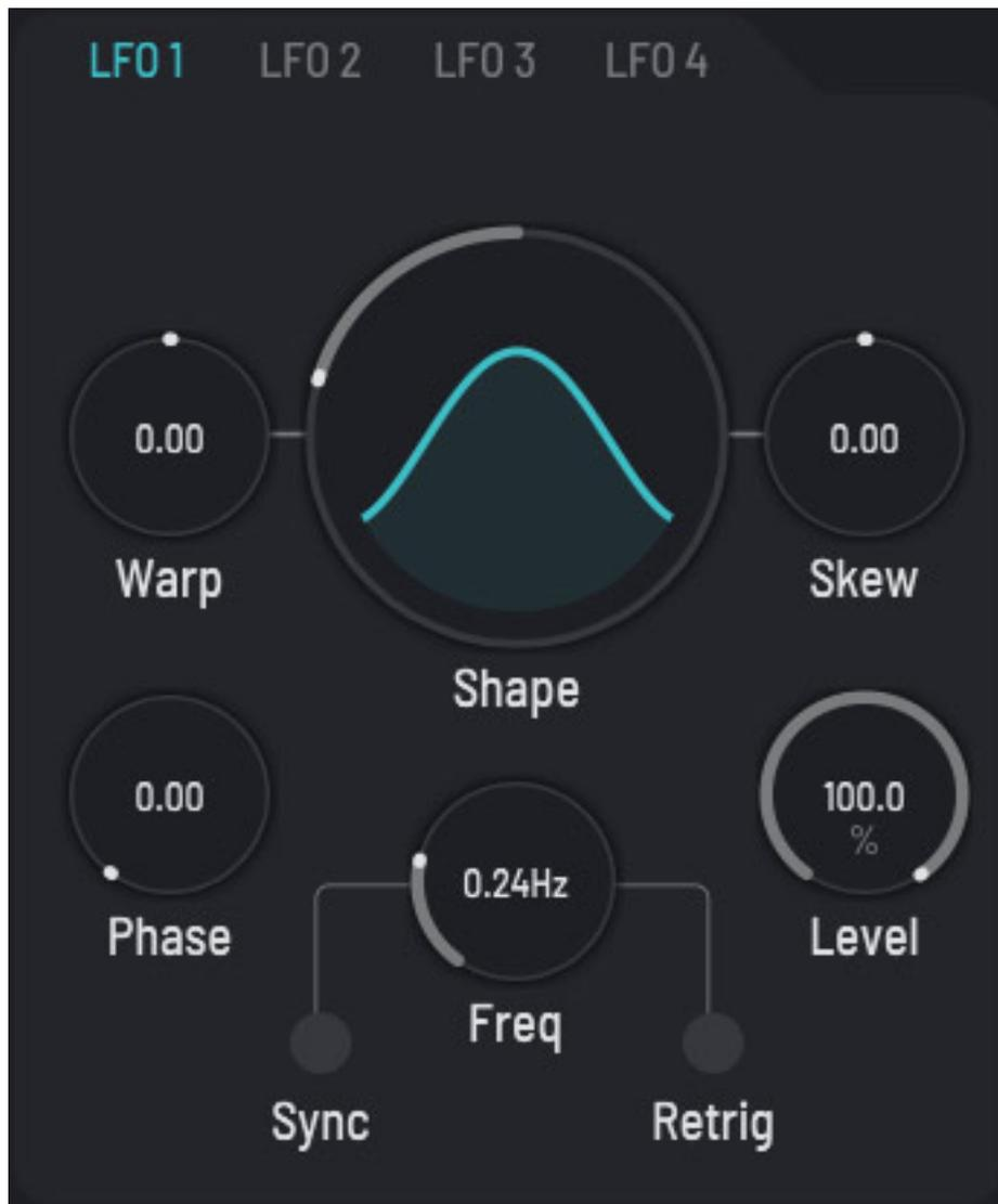
Natürlich dürfen auch LFOs nicht fehlen. Vier an der Zahl sind hier vorhanden und die Wellenform lässt sich wie bei den Audiooszillatoren über Shape, Warp und Skew einstellen und die resultierende Wellenform wird auch grafisch ausgegeben. Zudem kann man die Phase verändern und die Frequenz lässt sich auch mit der DAW-Taktrate synchronisieren und kann auch moduliert werden und auch eine Re-Trigger-Funktion ist vorhanden. Der Ausgangs-Modulationsgrad kann auch hier individuell eingestellt werden.
