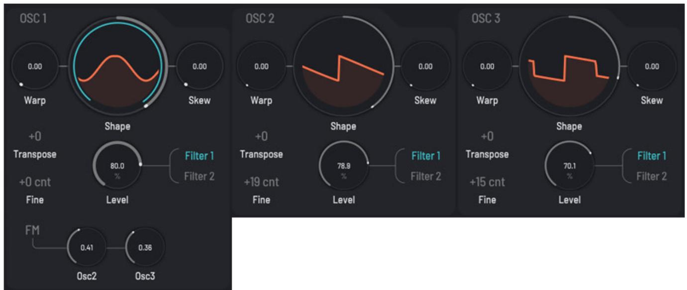
Die drei Oszillatoren sind identisch aufgebaut bis auf die Tatsache, dass Oszillator 1 von Oszillator 2 und 3 auch FM-moduliert werden kann, Der Modulationsgrad lässt sich dabei individuell einstellen. Jeder Oszillator lässt sich getrennt auf das Filter 1 oder 2 oder beide routen. Die Tonhöhe der Oszillatoren kann man in Halbtöne und Cent-Schritte individuell einstellen.
