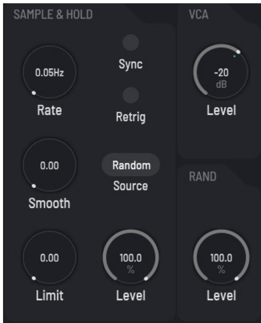
Zudem verfügt die Modulationssektion über ein virtuellen Sample & Hold. Als Quelle kann ein Zufallsgenerator, einen der vier Hüllkurvengeneratoren oder ein der vier LFOs angewählt werden. Auch hier sind Synchronisation und Re-Trigger möglich. Die Abtastrate des S&H sowie die Glättung (Parameter Smooth) und der Wertebereich (Parameter Limit) kann beeinflusst werden.
