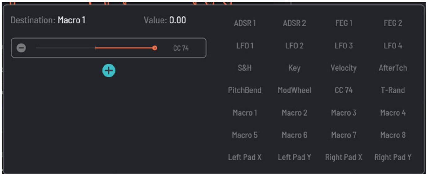
Hier kann man als Quellen auch die beiden virtuellen XY-Joysticks anwählen, die jeweils links und rechts neben dem Makro-Bereich auf der Bedienoberfläche angeordnet sind. Die Makro-Ausgänge lassen sich an den Parametern dann als Modulationsquelle auswählen, so wie zuvor beschrieben eine einzelne Modulationsquelle.
