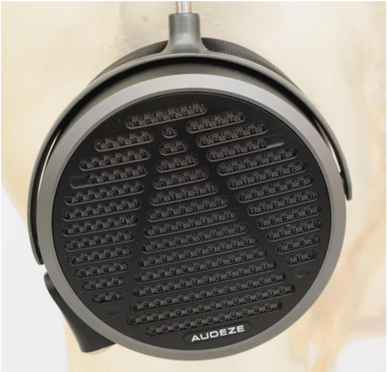
Fangen wir mal beim Schallwandler an. Bei alle Audeze-Kopfhörern handelt es sich ja um Kopfhörer mit magneto-statischen Wandlern. Es gibt hier also keine sich bewegende Spule in einem Magnetfeld. Wer mehr zu dem technischen Prinzip erfahren möchte, dem empfehlen wir den Test [LCD-2 Abschnitt Konzept und Technik](#) zu lesen.
