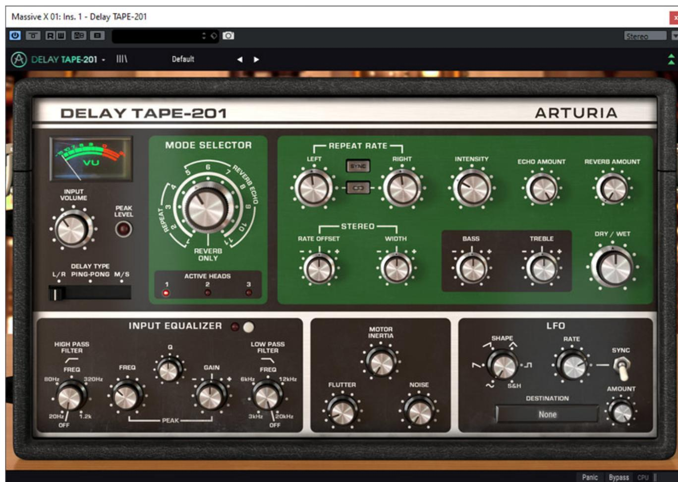
Oben ist daher das eigentliche Plug-In-Fenster aber man kann unten ein weiteren Dialog ausklappen, der noch weitere Zusatzfunktionen bietet, wie ein Eingangsequalizer, Zusatz-Modulationsparameter sowie ein LFO-Einstellbereich (s. Abb. oben).
