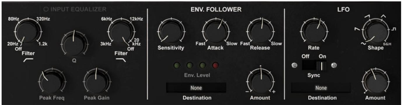
Und auch hier gibt es wieder den ausklappbaren Zusatzdialog mit Eingangs-Equalizer und LFO zur Parametermodulation wie beim Delay Tape-201. Da es keinen mechanischen Antrieb gibt, hat man hier statt deren Modulationsparameter einen Envelope Follower vorgesehen, der aus dem Eingangssignal eine Hüllkurve zur Steuerung von Parametern bereitstellt. Das Ziel kann auch wieder frei gewählt werden.
