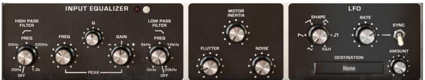
Damit aber nicht genug. Neben einem Ausgangs-EQ verfügt das Delay Tape-201 auch über einen parametrischen Eingangs EQ mit Hoch- und Tiefpaßfilter. Um die Unzulänglichkeiten der ursprünglichen Technik auch noch mit zu integrieren gibt es die "Noise" Zusatzfunktionen für die Simulation von Störgeräuschen, unter anderem verursacht durch den Antrieb. Mit "Flutter" werden zufällige Änderung der Wiedergabegeschwindigkeit durch Motordrehzahlschwankungen simuliert. Durch
