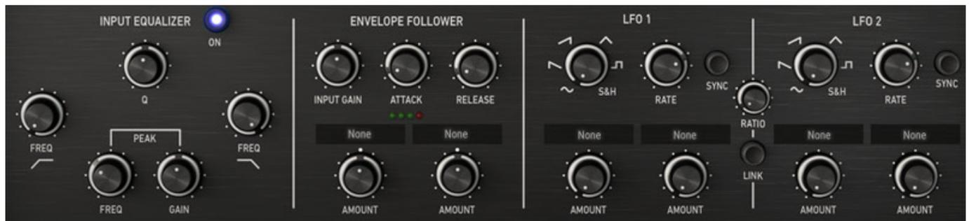
Bei dem ausklappbaren Zusatzdialog steht beim Eternity wieder ein Eingangs-Equalizer und ein Envelope Follower bereit sowie diesmal zwei LFOs, deren Rate sich auch verlinken lassen. Envelope Follower und die beiden LFOs bieten zudem jeweils die Anwahl von zwei Modulationszielen.
