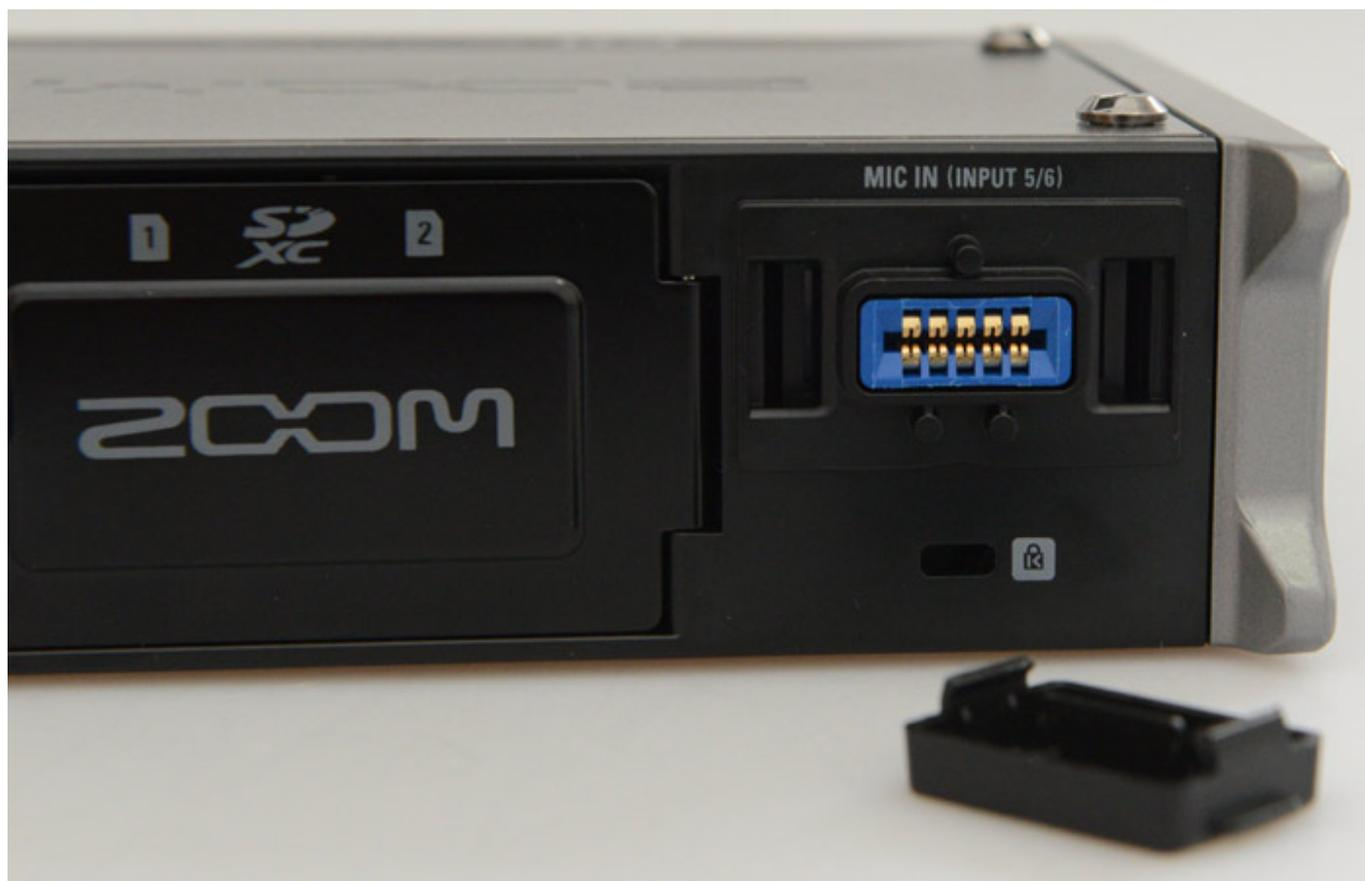
Rechts auf der Geräterückseite befindet sich unter einer Schutzabdeckung (s. Abb. oben) eine spezielle Buchse für die von Zoom verfügbaren Stereomikrofonkapseln. Auch diese werden ggf. auf die Spur 5/6 aufgezeichnet. Direkt darunter ist noch eine Befestigungsmöglichkeit über Kensington Secure Lock.
