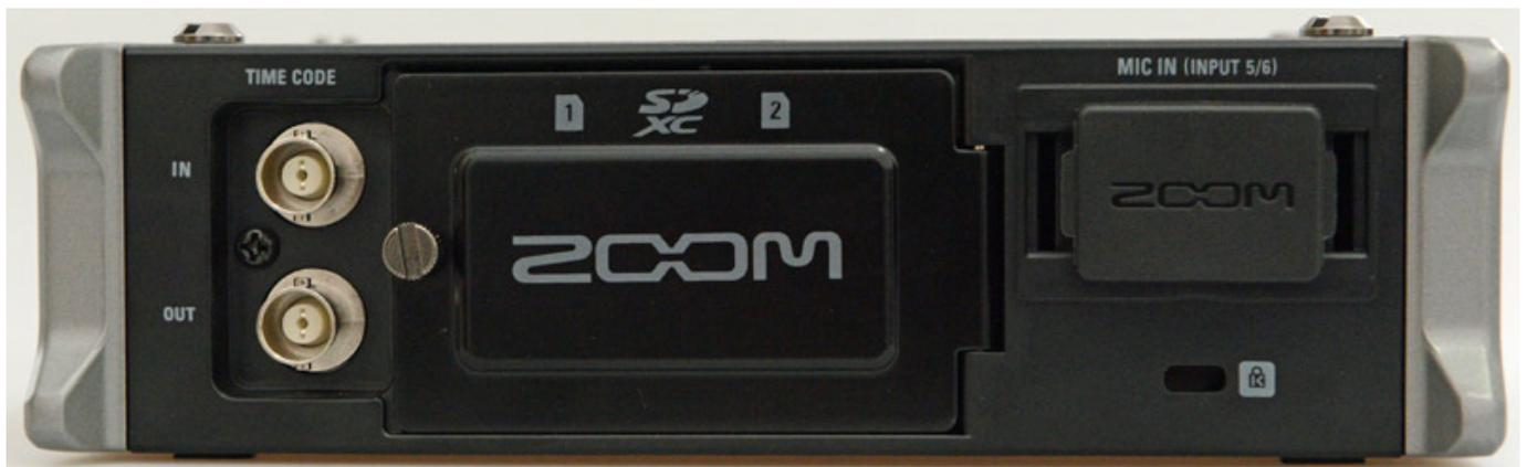
Auf der Rückseite sind linke Timecode-Ein- und Ausgang in Form von zwei BNC-Buchsen (s. Abb. oben) vorhanden.
