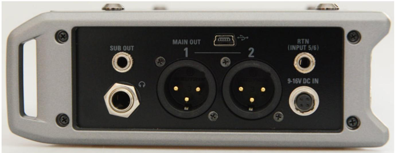
Weiter gibt es aber auch noch einen sogenannten Return Input 5/6. Er ist gedacht, um den Ton von einem in der Kamera integrierten Ton als Backup oder zu Synchronzwecken mit aufzuzeichnen.
