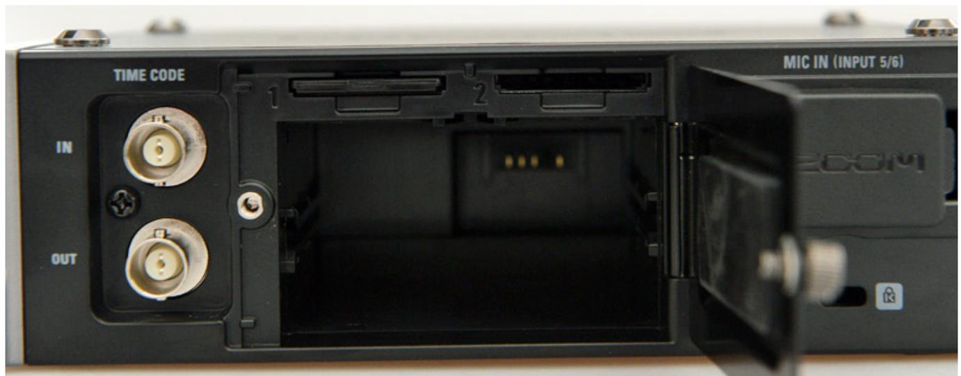
Die Zellen werden in einen Batteriekasten eingelegt (s. Abb. unten) und dieser dann nach Öffnen der Batterieabdeckung (s. Abb. oben) eingeschoben. Der Batteriekasten ist der übrigens der gleiche wie beim F8 und auch einzeln erhältlich. Daher ist ein schneller Tausch im Bedarfsfall möglich, da nur der vorbestückte Akkukasten zu wechseln ist.
