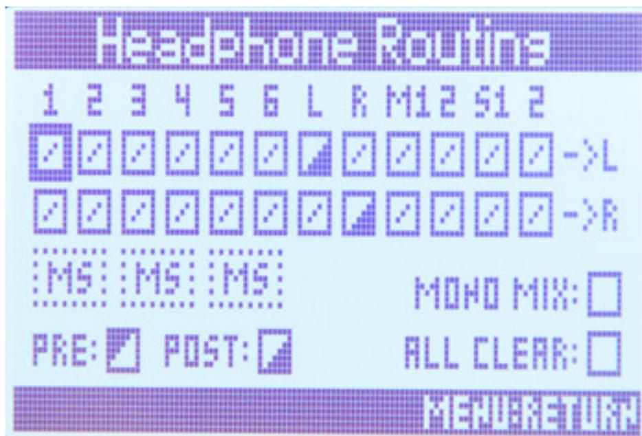
Beim Kopfhörer-Routing (s. Abb. oben) ist auch eine MS-Dekodierung für das Monitoring vorgesehen. Weiter lässt sich Pre/Post-Fader abhören.
