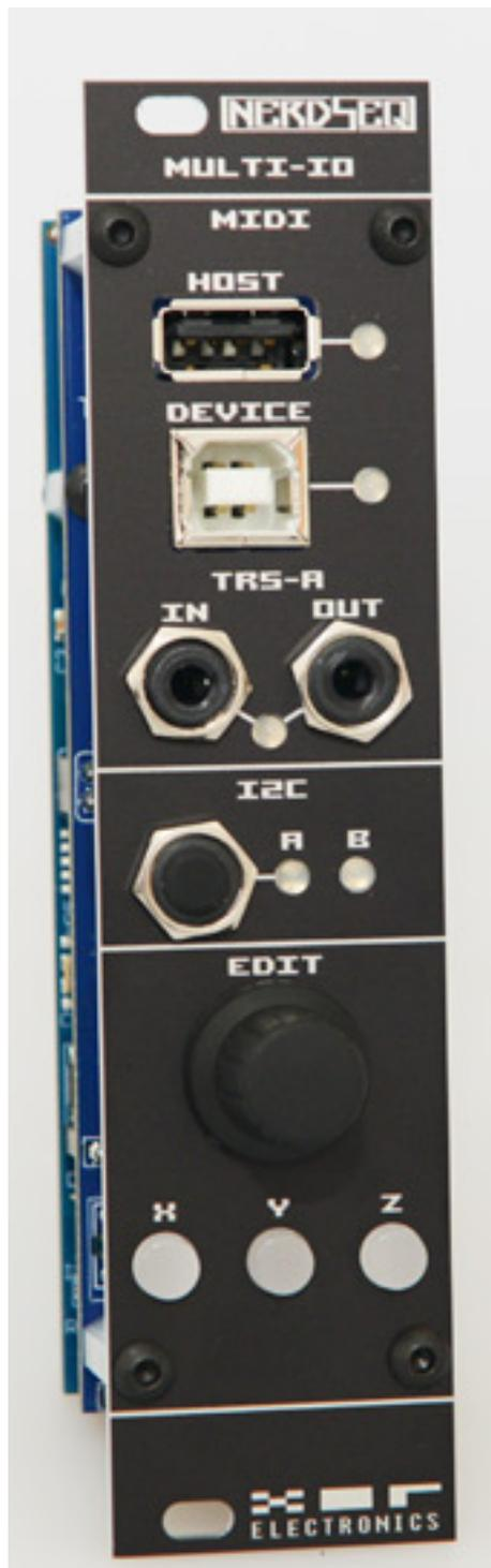
Der Multi-I/O verfügt über eine MIDI-Host-Buchse (USB-A) an dem sich zum Beispiel ein Launchpad (USB Class Compliant) anschließen lässt, aber auch USB-Hub-fähig ist und sich so mehrere Geräte an einem Port anschließen lassen wie ein Launch Pad und ein Keyboard etc. Weiter steht noch eine MIDI-Device-Buchse (USB-B) zum
