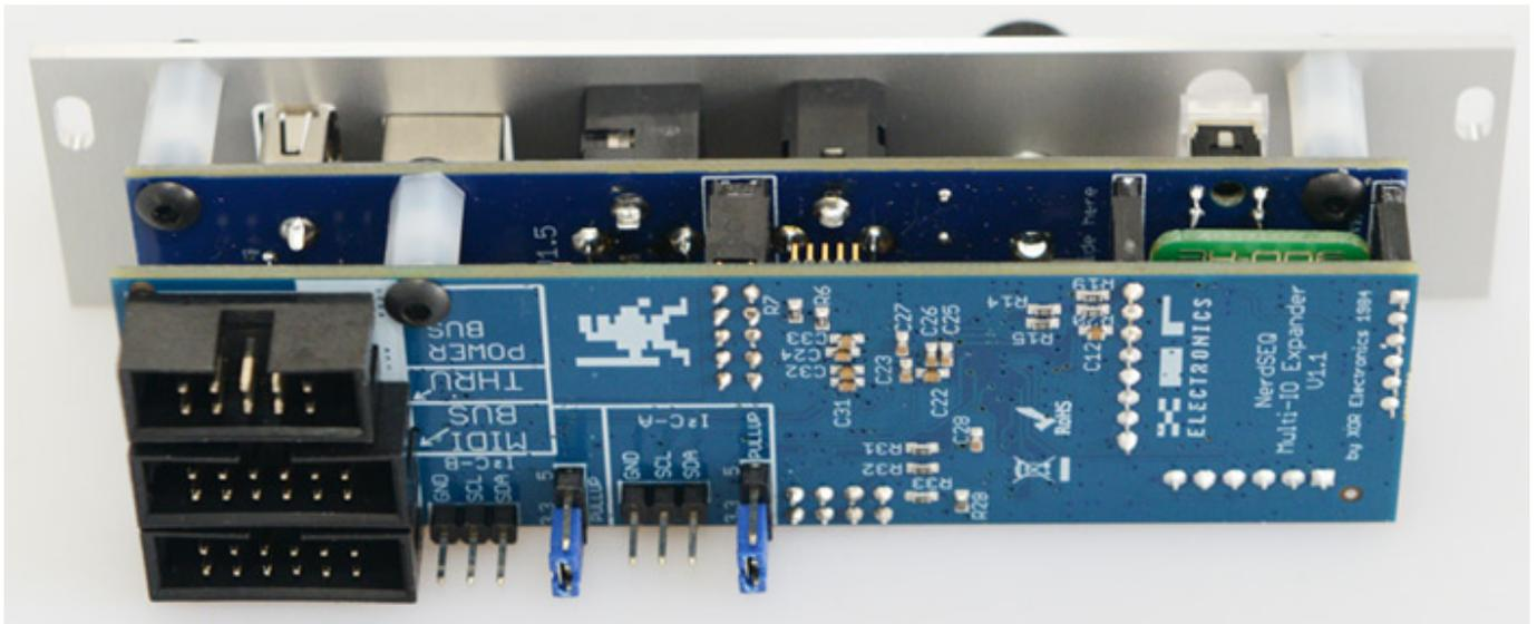
Auf der Rückseite befinden sich drei Anschlüsse und zwar für Spannungsversorgung und den internen MIDI-Bus sowie ein MIDI-Thru an dem man noch einen Gamepad Expander anschließen kann. Der Anschluss ist nicht für weitere MIDI-Expander gedacht denn in einem NerdSEQ-System wird nur bei einem Expander mit MIDI unterstützt.
