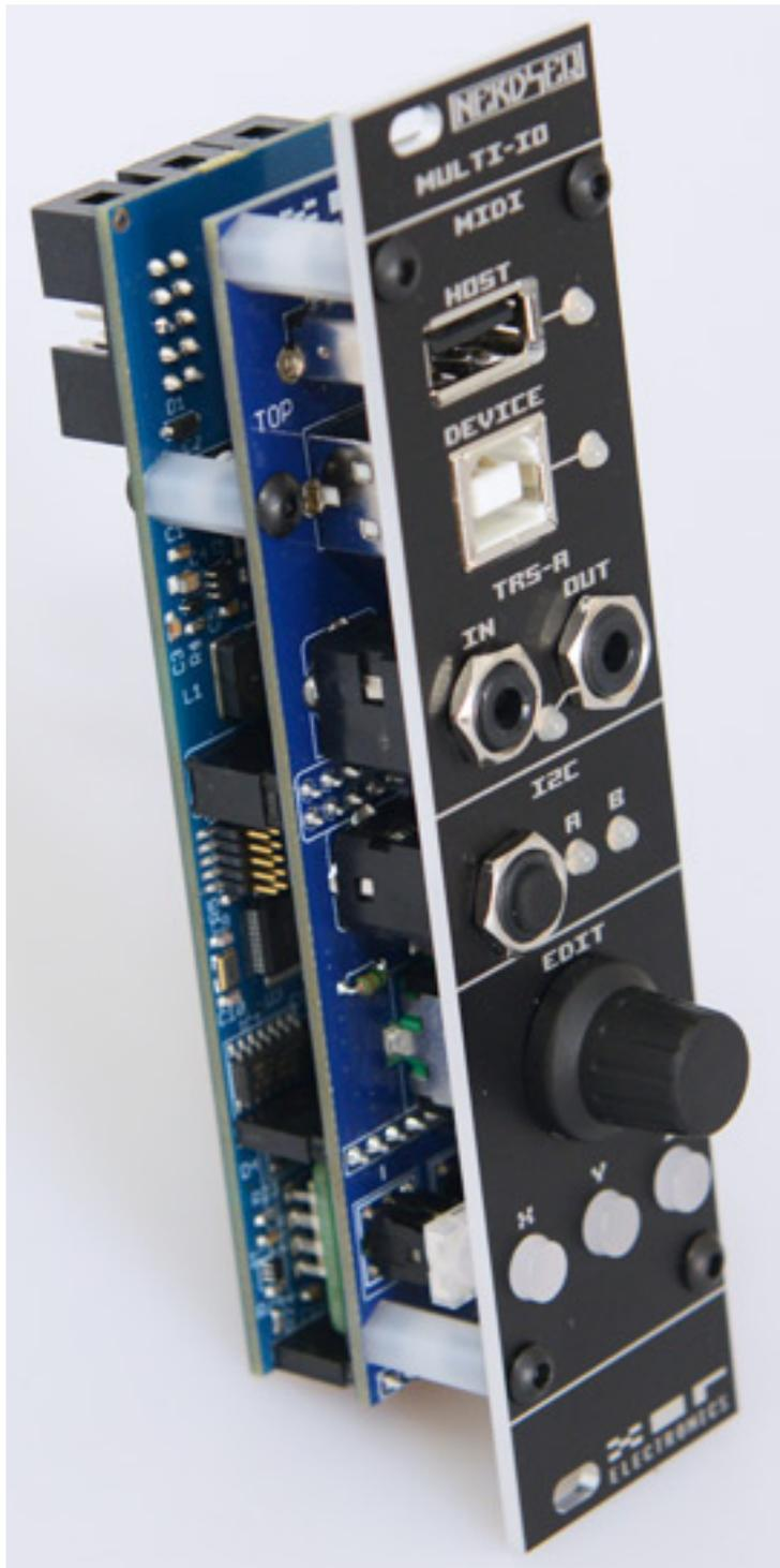
Neben dem I/O-Expander mit DIN-Buchsen und Anschluss für Sega Gamepad sowie dem kompakten 2HP MIDI-Expander mit Mini-TRS-Buchsen gibt es seit 2024 noch einen dritten Expander mit MIDI und zwar den Multi-IO Expander. Dieser Expander mit einer Breite von 6 HE verfügt eben nicht nur über MIDI sondern bietet darüber hinaus zusätzliche Funktionalität, wie I2C-Anschluss und auch einen Drehgeber mit drei Funktionstasten.
