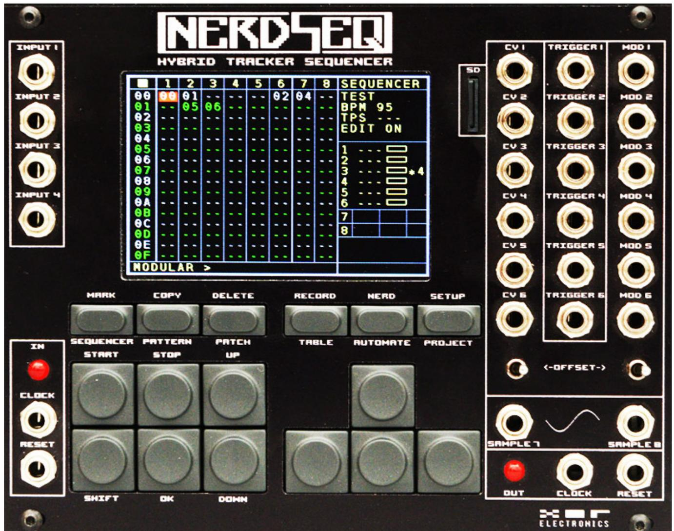
Werfen wir an dieser Stelle einmal einen Blick auf die Tasten zur Bedienung des NerdSEQ. Die obere Tastenreihe mit den kleineren Tasten dient dem Aufrufen der einzelnen Seiten, bzw. Dialoge, wie Sequencer, Pattern, Patch, Table, Automate und Project. In Verbindung mit der Shift-Taste kann man weitere Funktionen über diese Tasten aufrufen wie Markieren, Kopieren, Löschen, Aufnahmestart, Einstellungen etc.
