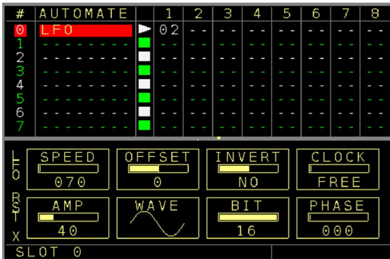
Hier nun noch ein Beispiel einer Automation (s. Abb. oben). In der NerdSEQ Version 1.21 kann man eine LFO oder einen der CV-Inputs pro Slot auswählen und dann auf einem Track einen bestimmten Parameter modulieren. In unserem Beispiel liegt ein LFO auf Spur 1 und moduliert den Parameter 02 (Gate-Länge).
