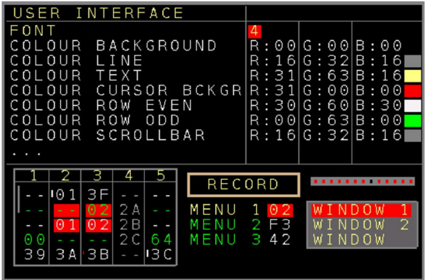
Wenn man weiter nach unten scrolled taucht auch ein Menüeintrag zum Aufruf der Individualisierung der Bedienoberfläche auf. Hier (s. Abb. oben) lassen sich Farben anpassen und die Systemschriftart verändern. Das potentielle Ergebnis wird in der unteren Hälfte als Beispiel ausgegeben. Ich habe als erstes die Standardschriftart geändert, die sehr schlecht lesbar ist. Alle hier dargestellten Seiten sind mit der Schriftzeichensatz 4 erstellt worden.
