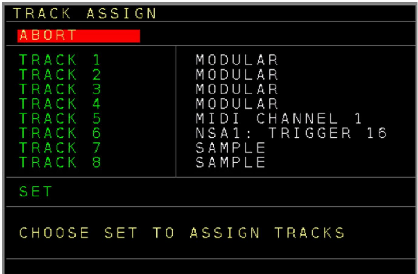
Hier kann man bei den Tracks 1 bis 6 die Ausgänge zuordnen. MODULAR sind dabei die 3 x 6 Outs auf dem NerdSEQ Basismodul. Es lassen sich aber auch Spuren für MIDI-Anwendung zuweisen oder einem der angeschlossenen Trigger-Out-Module.
