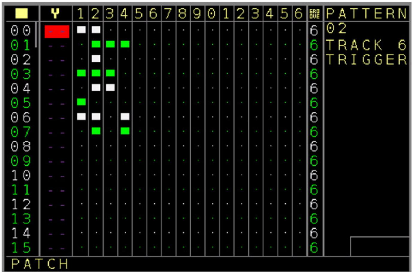
Bei den Spuren mit zugewiesenen Trigger-Out-Expander gibt es auch eine Seite, wo dem Anwender eine Grid-Darstellung angeboten wird um die Trigger für die einzelnen Ausgänge pro Step zu setzen (s. Abb. oben). Diese Editorseite versteckt sich etwas und man muss bis zum Ende durchscrollen.
