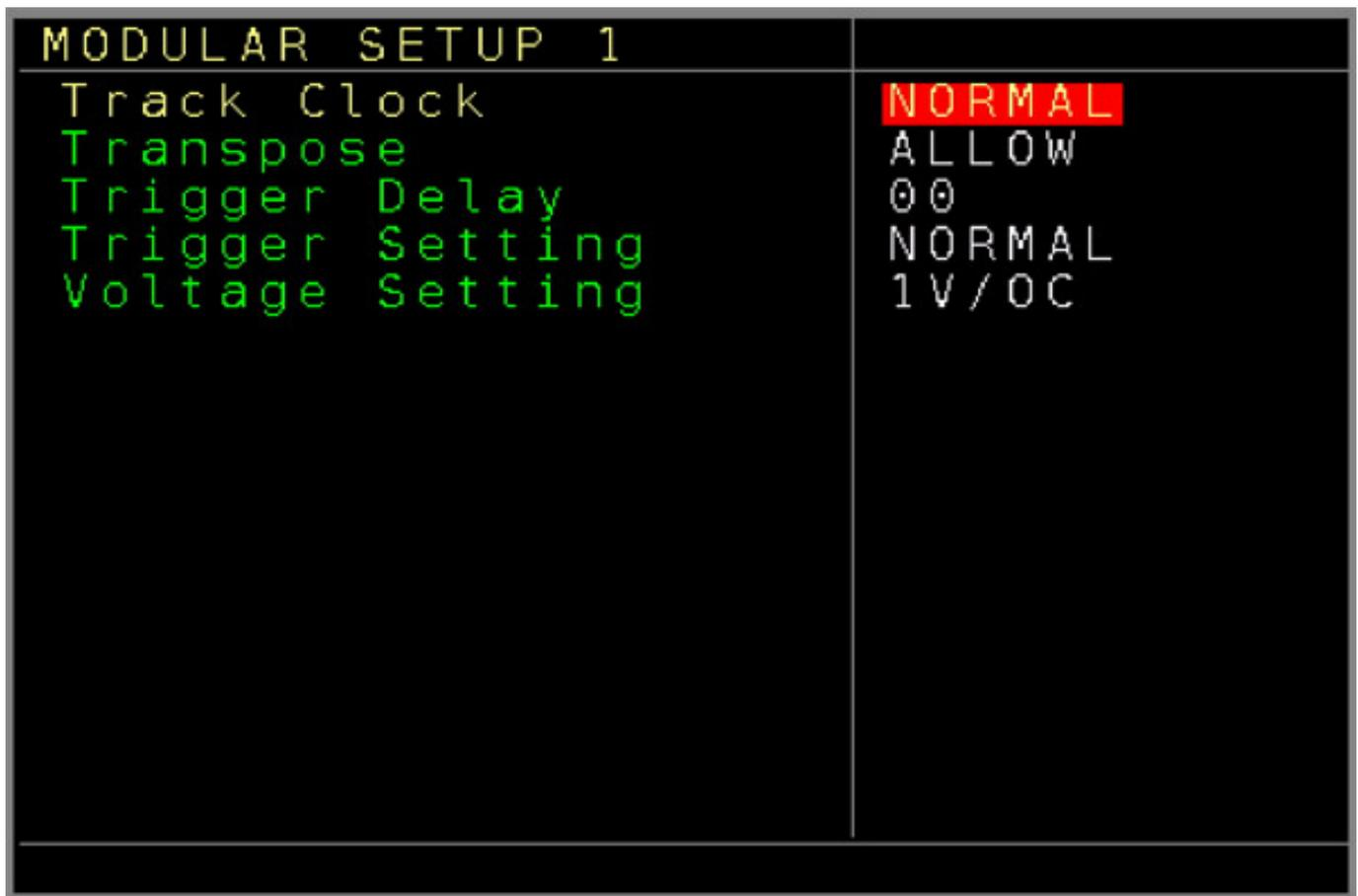
Wählt man hier eine Spur über die OK-Taste aus, so öffnen sich entsprechende Dialoge. Dort lassen sich zum Beispiel die Spurabspielgeschwindigkeit einstellen oder Transponierungen vornehmen etc. Bei den analogen Ausgängen (s. Abb. oben) kann man auch das Spannungsausgabeformat für die betreffende Spur zwischen 1 V/Oktave, 1,2 V/Oktave oder Hz/V wählen.
