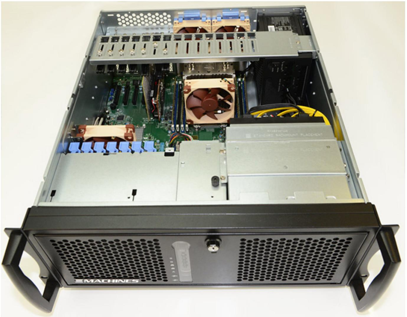
Die X2-Workstation in der 19-Zoll-Rack-Version haben eine Bauhöhe von 4 HE. Die X2 AUDIO, wie auch die X1 AUDIO und X3 AUDIO, sind optimiert für minimale Geräuschemission. Es werkeln sechs extrem leise 9-Blatt-Fans in verschiedenen Größen als Lüfter im System. Die X2-Workstation bietet sechs PCIe-Slots für unterschiedliche PCIe-Kartentypen.
