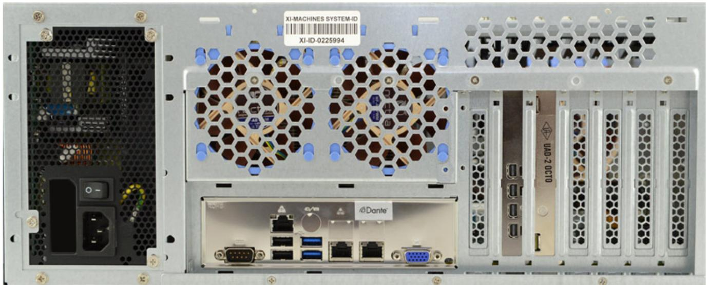
Standardmäßig bietet die X2-Workstation auf der Rückseite je zwei USB-2.0- und zwei USB-3.0-Schnittstellen sowie auf der Front weitere vier USB 2.0-Schnittstellen, zum Beispiel für Maus- oder Grafiktablett-Sender. Weiter befindet sich ein USB-Anschluss auch noch im Inneren des Gerätes. Das ist auch ganz praktisch, denn dort kann man zum Beispiel ein Software-USB-Lizenzschlüssel einstecken, der somit auch beim Einbau in ein Rack gesichert ist. Zudem lassen sich USB-Erweiterungen bestellen.
