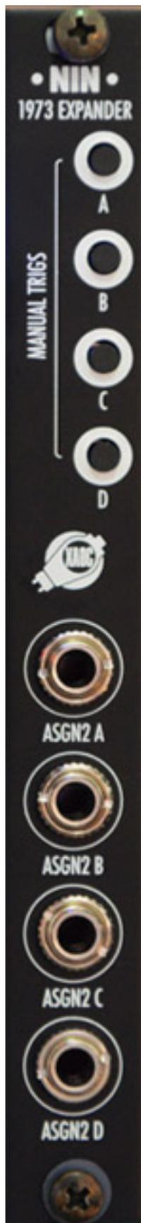
Das Nin erweitert jeden Kanal um einen weiteren Steuerspannungseingang (ASGN2 A ... D) und bietet zudem vier Trigger-Tasten, um einen der vier Hüllkurvengeneratoren manuell auszulösen.
