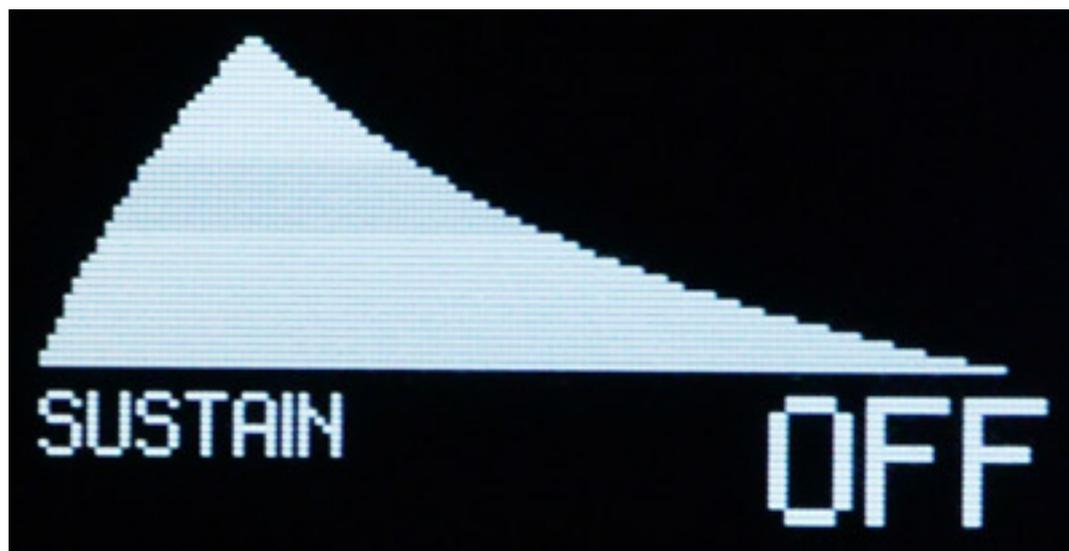
Es ist noch anzumerken, dass es zwei Retrigger-Betriebsarten beim Zadar gibt und zwar "Analog" (AN) und "Digital" (DG). Bei Digital startet die Hüllkurve immer am Anfang sobald ein Trigger-, bzw. Gate-Signal detektiert wird. Bei der Betriebsart Analog beginnt der Hüllkurvengenerator die Hüllkurve an dem aktuellen Pegel. Der Modus Digital ist also mit dem Retrigger-Verhalten eines klassischen ADSR-Hüllkurvengenerators gleichzusetzen.
