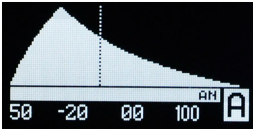
Wenn der Zeitpunkt ganz nach rechts verschoben wird schaltet sich die Sustain-Funktion aus (s. Abb. unten), wie man das beim klassischen Hüllkurvengenerator von der Umschaltung von ADSR- auf AD-Betriebsart her kennt. Die Hüllkurve wird dann lediglich getriggert und läuft ohne Tastaturkontrolle ab.
