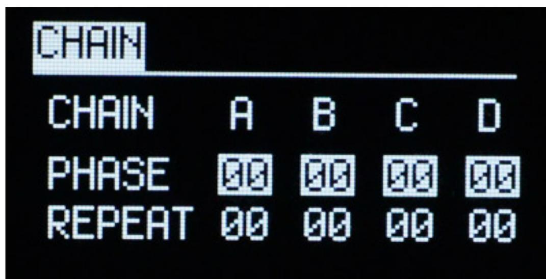
Als Modulationsziele im Modulationsmenü hat man die selektierte Hüllkurvenform, Länge, Warp- und Response-Parameter, sowie Level, Wiederholungsanzahl und Phase der Chain-Funktion, Reverse-Funktion, Sustain-Zeitpunkt und ein Freze-Schwelle. Mit der Freze-Funktion lässt sich der aktuelle Pegel der Hüllkurve halten.
