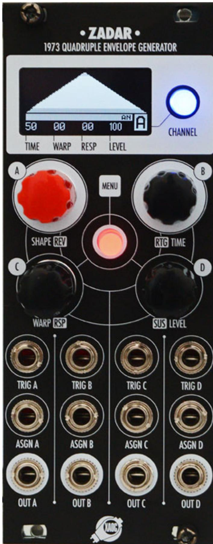
Das Modul bietet vier unabhängige Hüllkurvengeneratoren. Für jeden Kanal gibt es einen Gate-Input (TRIG A ... D), einen Hüllkurvenausgang (OUT A ... D) sowie einen zuweisbaren VC-Steuereingang (ASGN A ... D).
