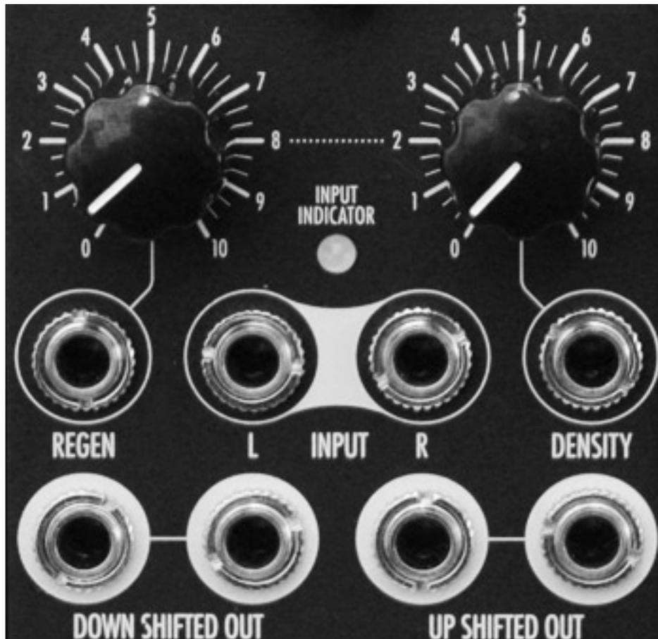
Im unteren Bereich befinden sich Ein- und Ausgangsbuchsen sowie auch einen Multi-Color-LED-Indikator für den Eingangspegel. Wenn er anfängt in die Farbe Rot zu wechseln, dann werden 16 Volt Spitze-Spitze-Pegel überschritten. Neben den beiden Eingängen bietet Koszalin zwei Paare von Stereo-Ausgängen (L/R) und zwar einmal hoch (UP SHIFTED) und einmal heruntergemischt (DOWN SHIFTED), bzw. wenn der Frequenzregler im negativen Bereich steht entsprechend umgekehrt.
