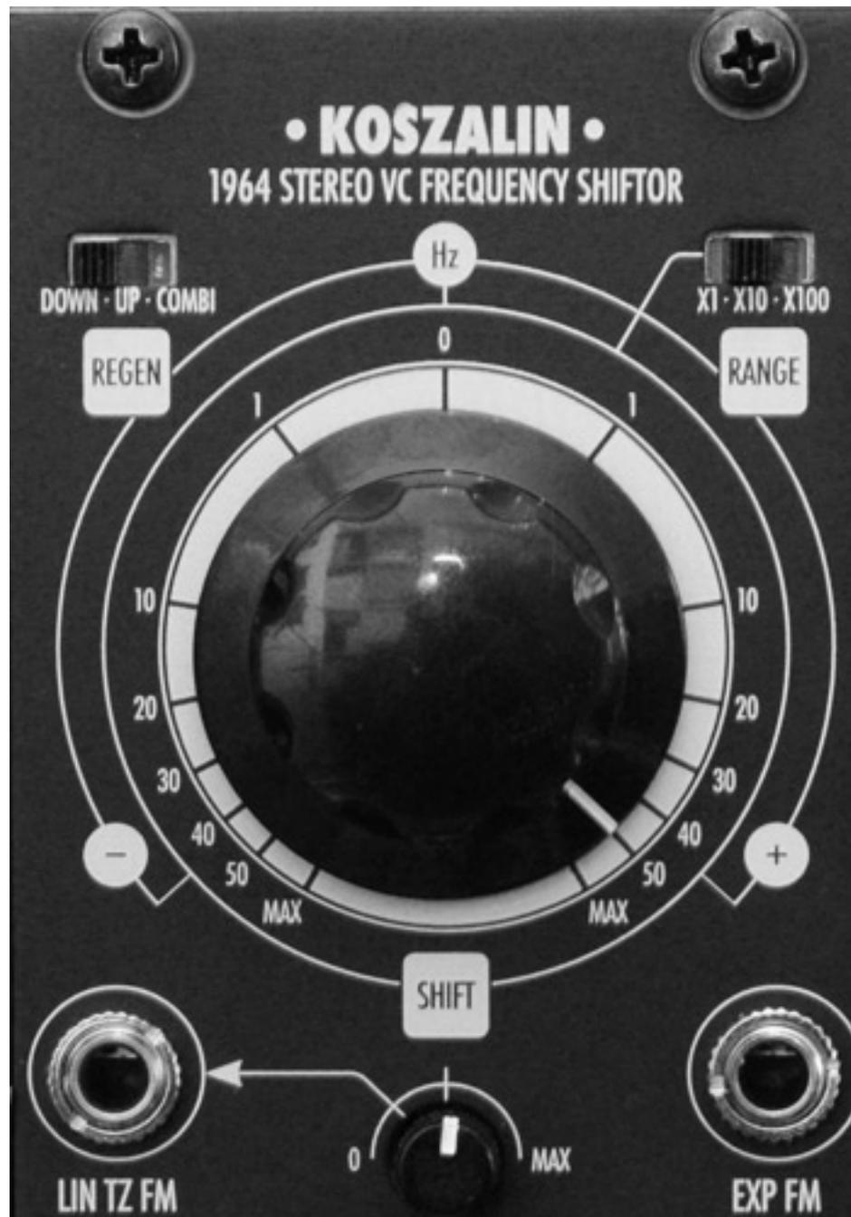
Koszalin ermöglicht auch eine Frequenzmodulation über einen linearen FM-Eingang mit Through-Zero Frequency Modulation und Eingangsabschwächer sowie einen exponentiellen FM-Eingang (s. Abb. oben).
