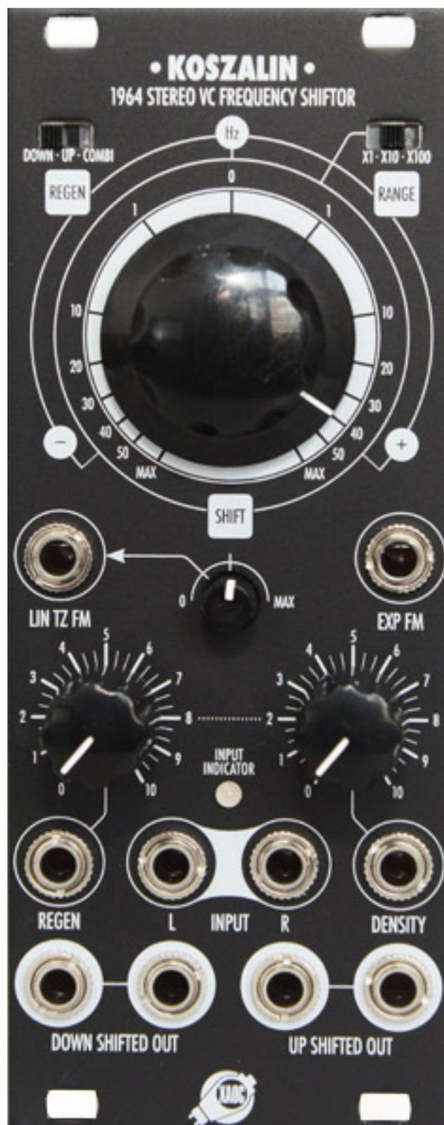
Schauen wir uns zunächst die Bedienelemente näher an. Oben befindet sich der große Regler für die Einstellung des Frequenzversatzes. Über einen kleinen Schiebeschalter lässt sich einstellen, mit welchem Multiplikator der Regler arbeiten soll, also Faktor 1, 10 oder 100. Der Regelbereich ist dann -50 ... +50, -500 ... +500,
