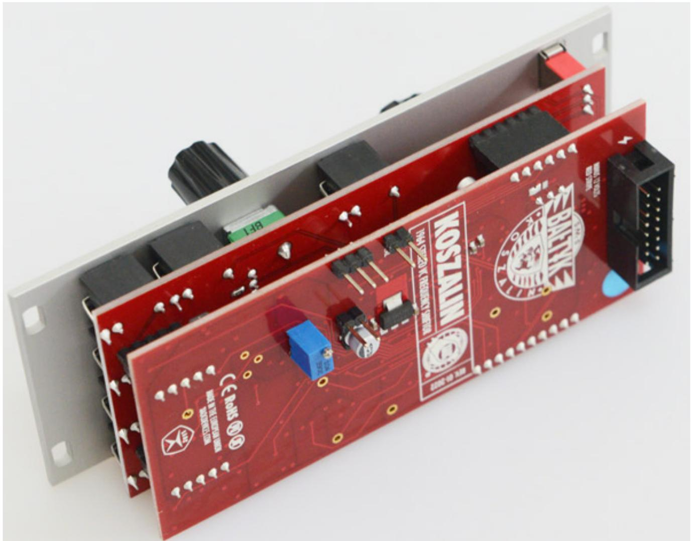
Im Gegensatz zu den zuvor erwähnten Frequency-Shifter-Modulen oder 19"-Geräten ist Koszalin eine Modul mit einem digitalen Ansatz und DSP-Technik und das Modul bietet Stereo-Ein- und Ausgänge auch mit einer Feedback-Möglichkeit. Die Signale werden so mehrfach verschoben und in der Frequenz versetzt.
