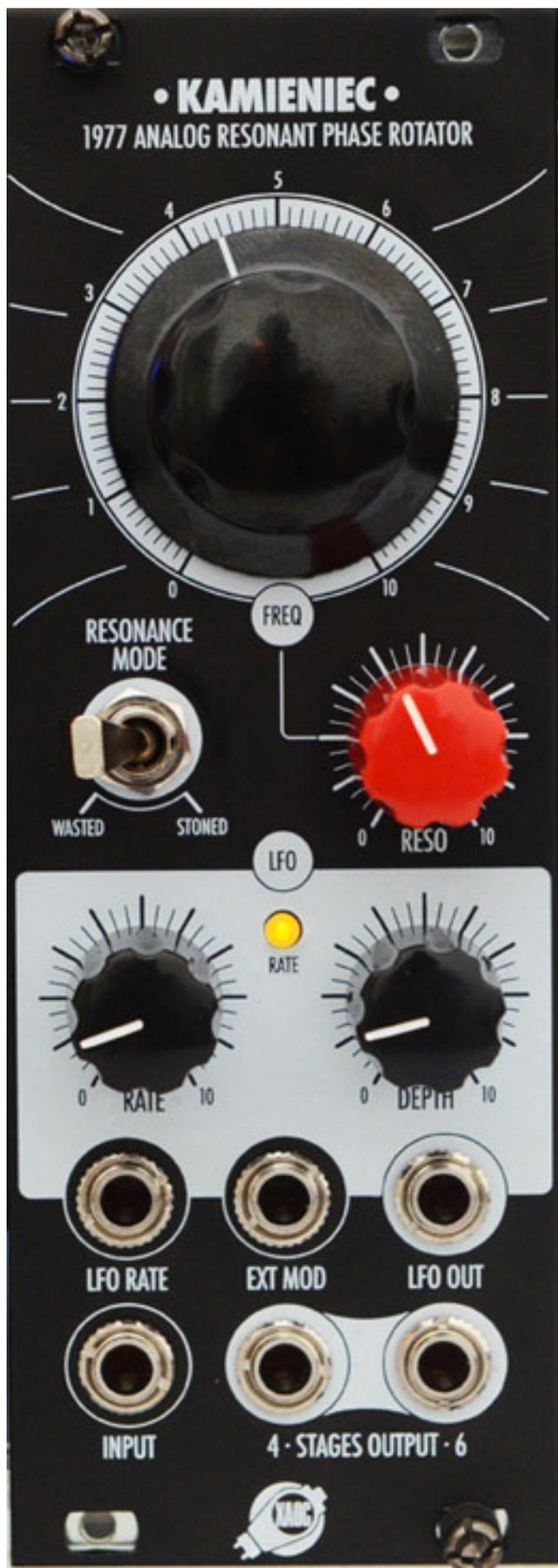
Die unteren beiden schwarzen Regler dienen der Einstellung des LFOs und zwar einmal der LFO-Rate und dann der Modulationstiefe. Wenn ein externes Modulationssignal über EXT MOD zugeführt wird lässt sich mit dem DEPTH- Reglers auf Linksanschlag die Modulation des internen LFOs komplett unterdrücken, so dass nur noch das externe Signal die Modulation durchführt. Über eine LED wird der Pegel des internen LFOs angezeigt.
