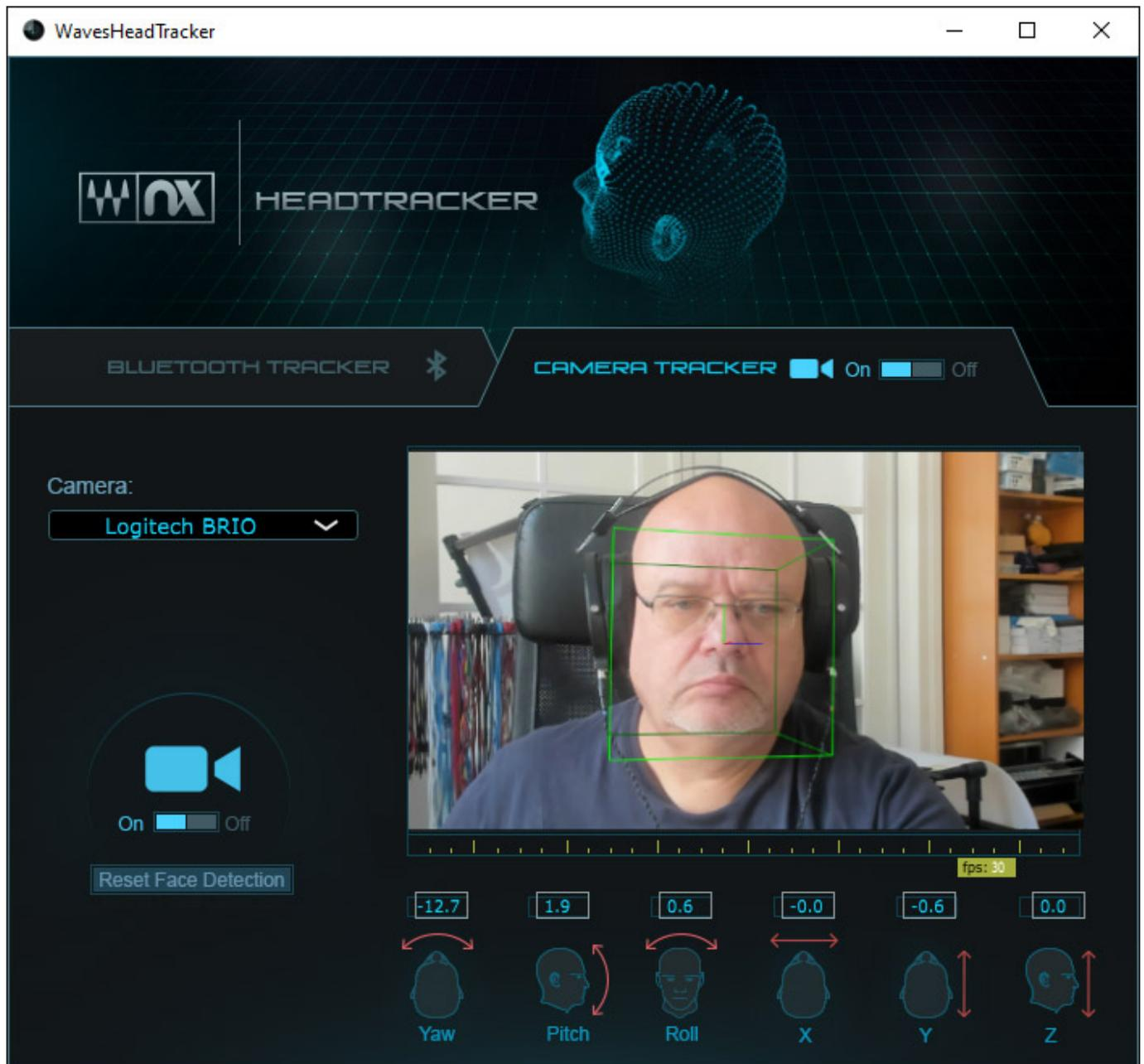
Eine andere Möglichkeit ist die Erkennung der Kopfposition über eine angeschlossene USB-Kamera. Die Kopfposition im Raum wird dann über das Videobild der Kamera berechnet (s. Abb. oben).
