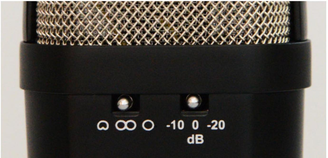
Auf der Vorderseite des Mikrofons gibt es zwei Kippschalter und zwar einmal zum Umschalten der Richtcharakteristik von Niere auf Acht und Kugel sowie einen weiteren für das Zuschalten einer 10- oder 20-dB-Vordämpfung.
