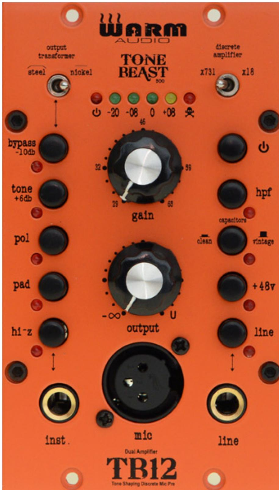
Nun zu den vielen Schaltern. Oben mit den beiden Kippschaltern neben der Bargrafanzeige gestattet die Umschaltung der Ausgangstransformatoren (Stahl/Nickel) und der Operationsverstärkertypen (1731 oder 918). Über einen Druckschalter unter dem Übertragerwahlschalter lässt sich der Ausgangsübertrager
