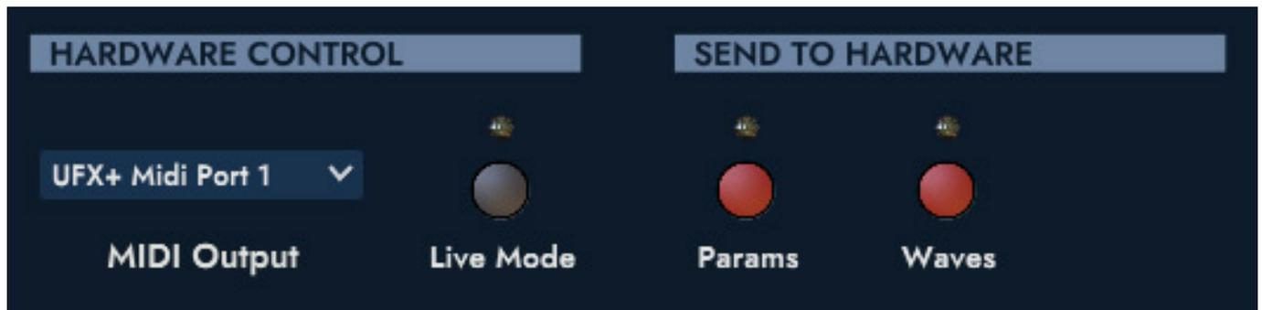
Hier lassen sich auch Dialoge für die Kontrolle eines angeschlossenen Microwave (s. Abb. oben) aufrufen. Es gibt in dem Hardware Control Dialog einen Live-Modus und Parameter lassen sich getrennt von den Wavetable-Daten übertragen.
