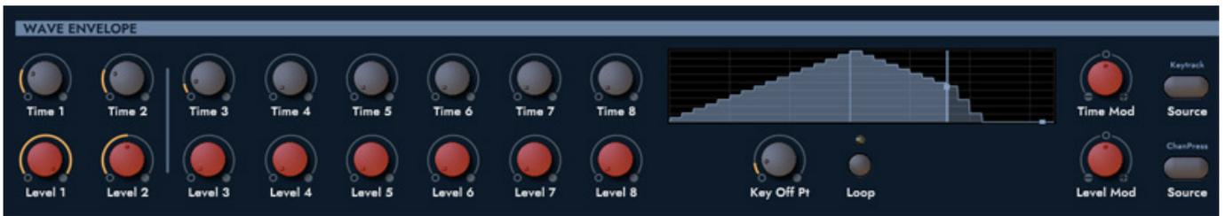
So lassen sich hier die Hüllkurven für den Ablauf der Wavetable editieren. Bei den Hüllkurvengeneratoren lassen sich acht Segmente einstellen und jeweils hier die Länge, bzw. Zeit sowie der Pegel nach Beendigung des Segmentes.
