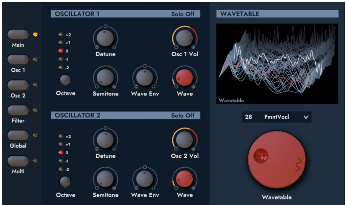
Die Main Section bietet eine Übersicht über die beiden Oszillatoren. Beide Oszillatoren nutzen ja die gleiche Wavetable aber sie lassen sich gegeneinander verstimmen und auch der Modulationsindex für die Ansteuerung der Wavetable ist individuell einstellbar.
