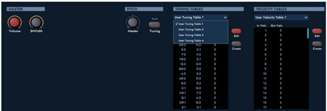
Über die Globale Section kann der Anwender eigene Skalen anlegen, wobei auch Microtonalität unterstützt wird und auch die Velocity-Tabellen lassen sich anpassen.
