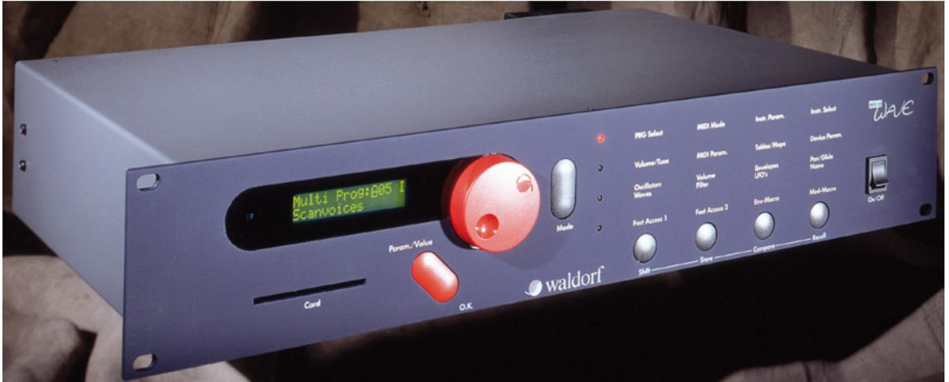
Die erste Generation des Waldorf Music Microwaves nutze ein ASIC (Abk. für Application-Specific Integrated Circuit - also eine anwendungsbezogene Integrierte Schaltung) für die Umsetzung der Wavetable-Generierung und Filter-Chips von Curtis. Auch schon beim PPG Wave 2.x wurden ja hinter der digitalen Tonerzeugung Filter-Chips von Curtis (Typ SEM 2044) eingesetzt. Beim Microwave gibt es übrigens zwei Hardware Revisions mit unterschiedlichen Filtertypen.
