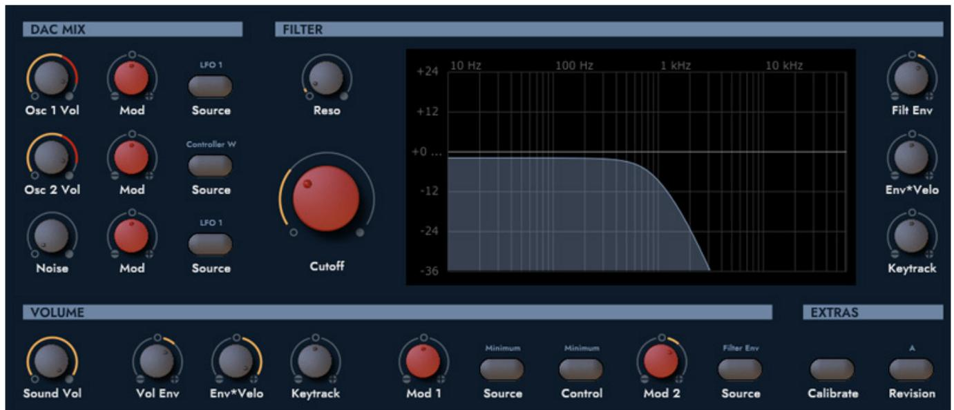
Auch in der Filtersektion werden gegenüber der Main Section deutlich mehr Parameter geboten. Hier lassen sich aber auch die beiden Oszillatoren und ein Rauschgenerator im Pegel über einen Mischer anpassen und auch modulieren. Wir hatten ja erwähnt, dass es eine Revision A und B mit unterschiedlichen Filtertypen beim Original gab. Über einen Revision-Schalter lässt sich auch dies im Plug-In anpassen.
