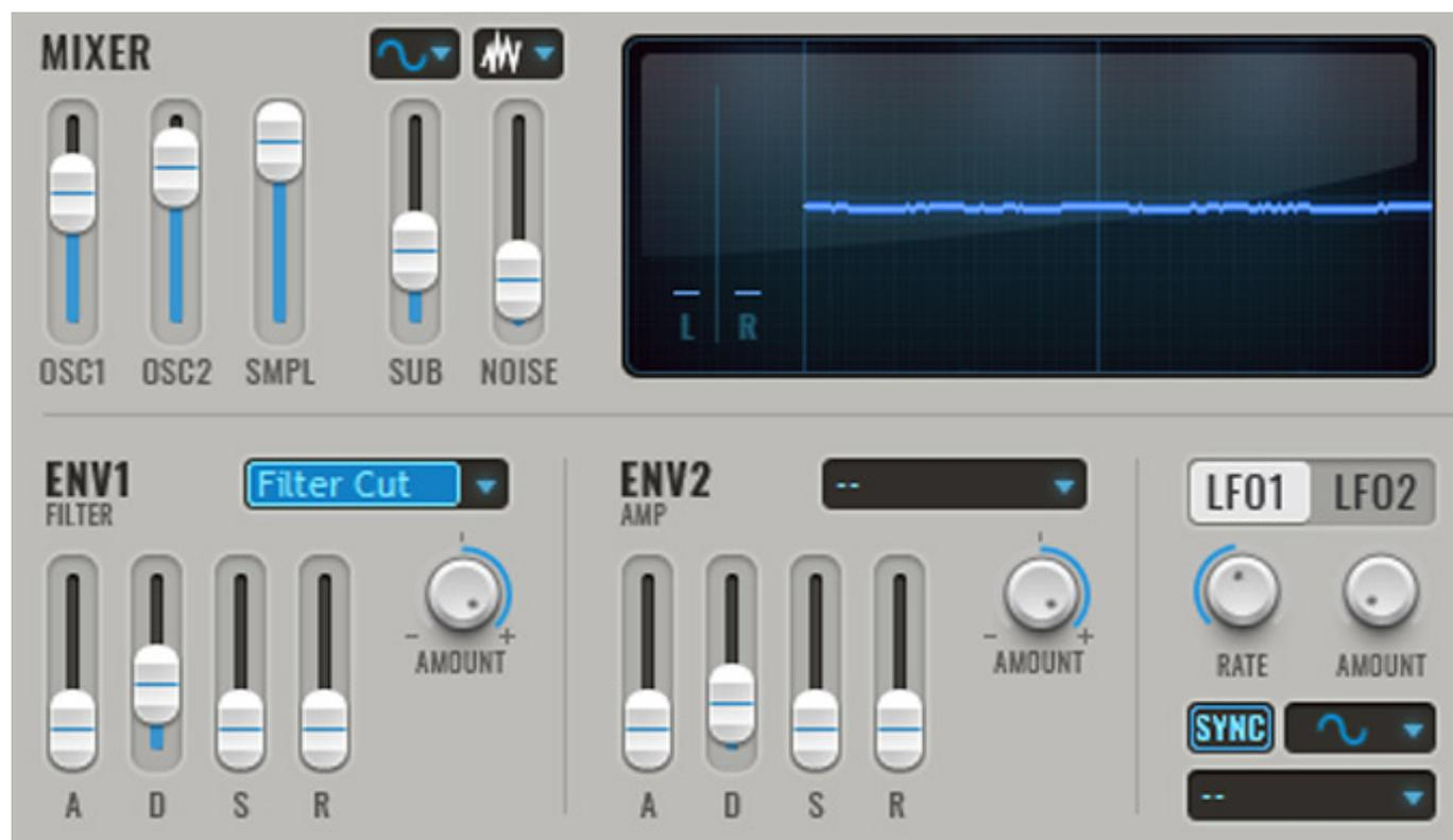
Als Modulationsquellen stehen zwei ADSR-Hüllkurven-Generatoren für den virtuellen VCA und dem Filter zur Verfügung sowie zwei LFOs mit verschiedenen Wellenformen, die sich auch synchronisieren lassen.
