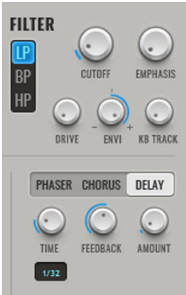
Im Signalweg folgt nach dem Mischer ein Filter (s. Abb. oben), welches als Hoch, Tief- oder Bandpass betrieben werden kann. Weiter lässt sich der Eingangspegel, die Filtergüte, die Wirkung der Filter-Hüllkurve und die Stärke des Keyboard-Frequenz-Trackings einstellen.
