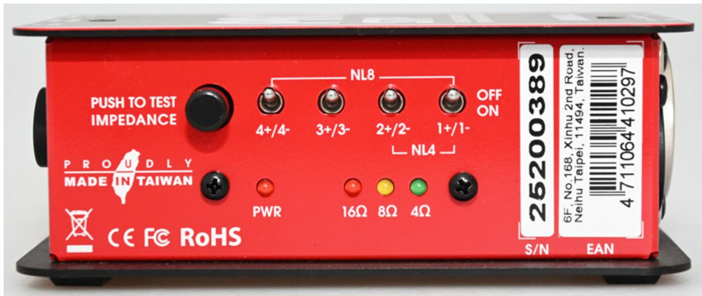
Die Bedienelemente sind übersichtlich angeordnet und selbsterklärend beschriftet. Die vier Umschalter für die Speakon-Ausgänge ermöglichen eine schnelle Kanalauswahl ohne Kabel umstecken zu müssen. Das Batteriefach ist leider nicht werkzeuglos zu öffnen, sondern erfordert den Einsatz eines Kreuz-Schraubendrehers. Für den Betrieb werden vier AA-Batterien benötigt. Diese sollen bis zu zwanzig Stunden Dauerbetrieb ermöglichen.
