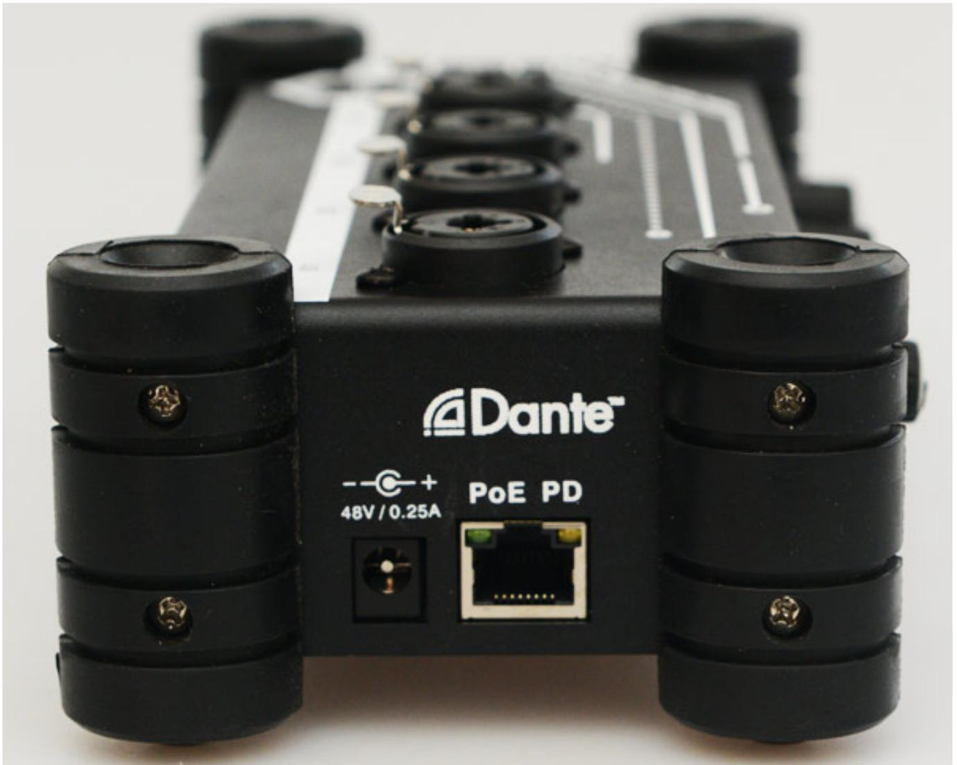
Die Betriebsspannung erfolgt über ein mitgeliefertes 48-Volt-Steckernetzteil oder über Power-over-Ethernet (PoE), wenn die Interfaces an einem PoE-fähigen Switch angeschlossen sind. Die Leistung eines Devices liegt bei unter sechs Watt.
