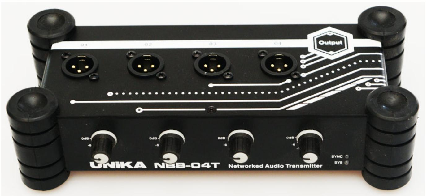
Das Konzept und Design vom Sender und Empfänger sind fast identisch. Die analogen Eingänge beim Sender verfügen zusätzlich über eine zuschaltbare 48-Volt-Phantomspeisung und die XLR-Buchsen sind natürlich entsprechend unterschiedlich, das heißt XLR-3-M-Buchsen beim Sender und Kombibuchsen XLR-3-F/6,3-mm-Klinke beim Empfänger.
