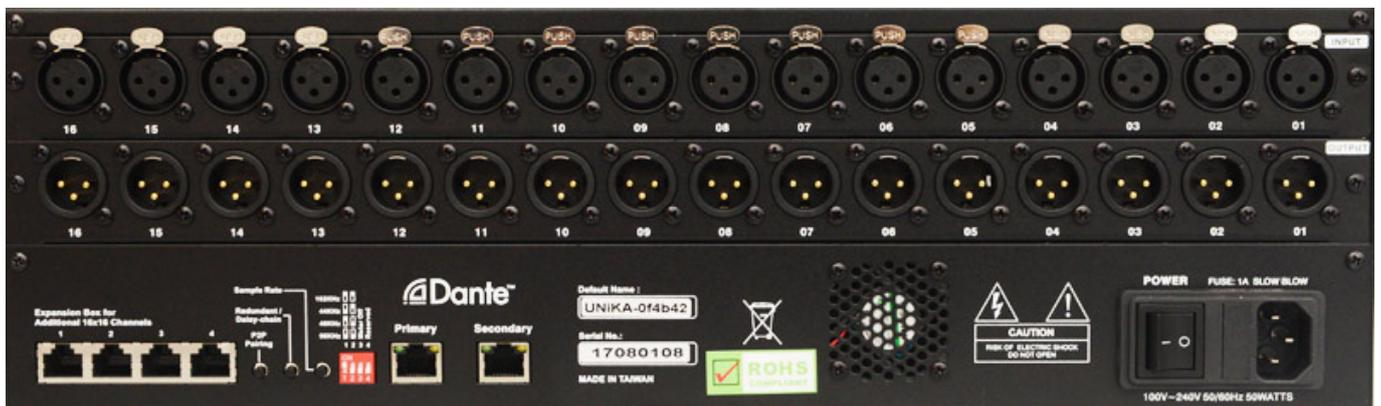
Alle Ein- und Ausgänge sind symmetrisch und als XLR-Buchsen ausgeführt. Der Ausgangspegel beträgt maximal 24 dBu und der Eingangspegel maximal 42 dBu. Der Störabstand gibt der Hersteller auf den Ein- und Ausgängen mit >110 dB an. Der Crosstalk bei 1 kHz liegt bei den Eingängen bei <-95 dB und bei den Ausgängen bei <-120 dB.
