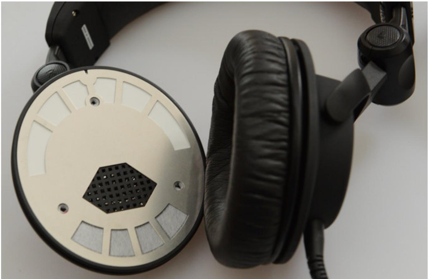
Der Wandler hat einen Durchmesser von 40 Millimeter und die Membrane besteht aus Mylar, also eine Kunststoffolie aus dem Werkstoff Polyethylenterephthalat, welche mit Titan beschichtet ist. Die eingesetzten Magnete bestehen aus einer Legierung von Neodym, Eisen und Bor. Als Frequenzgang gibt der Hersteller beim Signature Studio 8 Hz bis 40 kHz an. Die nominale Impedanz beträgt 32 Ohm und der Kennschalldruck 98 dB SPL.
