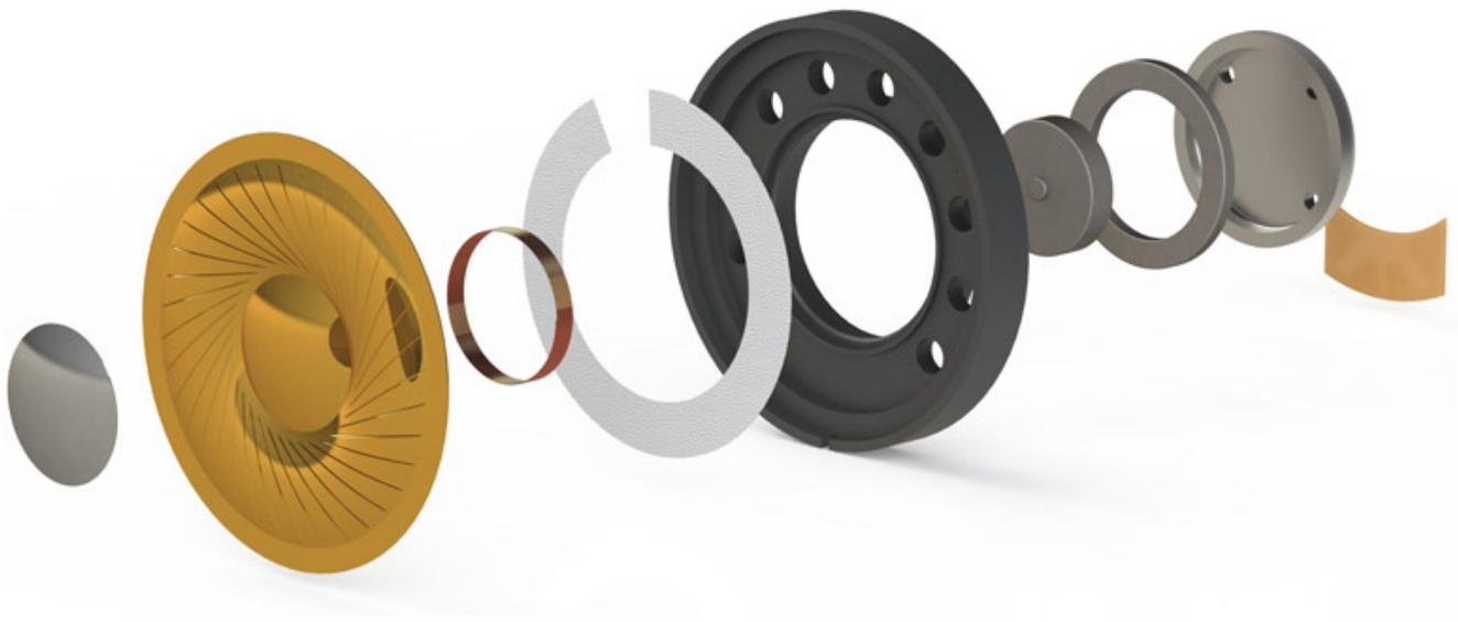
Wie der Name es vermuten lässt besteht der Treiber aus einer Kombination von goldbedampfte Mylar-Membrane mit einer im Zentrum angeordneten Titanium-Kalotte, die für die Abstrahlung der höheren Frequenzen zuständig ist. Das sieht man auch sehr gut im oben abgebildeten Foto. Der Hersteller verspricht durch den Einsatz dieser Technik einen größeren Übertragungsbereich mit einer präziseren Wiedergabe. So gibt Ultrasone einen Übertragungsbereich von 5 bis 48 kHz an.
