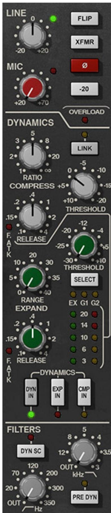
Weiter ist in der linken Sektion die Dynamikeinheit bedienbar und ganz unten das Hochpass-/Tiefpaßfilter, welches sich beim Legacy Plug-In ganz oben befindet. Es gibt also auch marginale Unterschiede bei der Bedienoberfläche der beiden Plug-Ins. Beim Filter gibt es die Möglichkeit über zwei Schalter es in den Sidechain einzufügen oder vor der Dynamikeinheit zu schalten.
