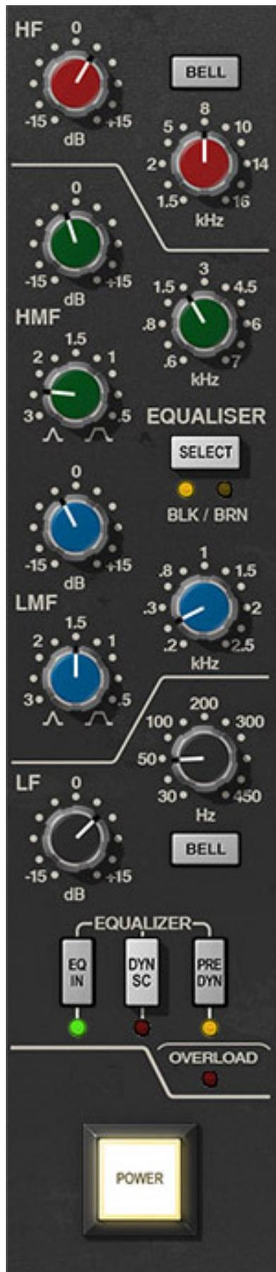
In der Mitte befindet sich die Filtersektion mit zwei vollparametrischen (LMF und HMF) und zwei halbparametrischen Filtern (LF und HF). Letztere lassen sich über den Schalter BELL auf Shelf- oder Glocken-Filtercharakteristik umschalten. Über drei Schalter kann der EQ in den Signalweg oder Sidechain eingeschliffen und auch vor der Dynamik-Einheit gesetzt werden.
