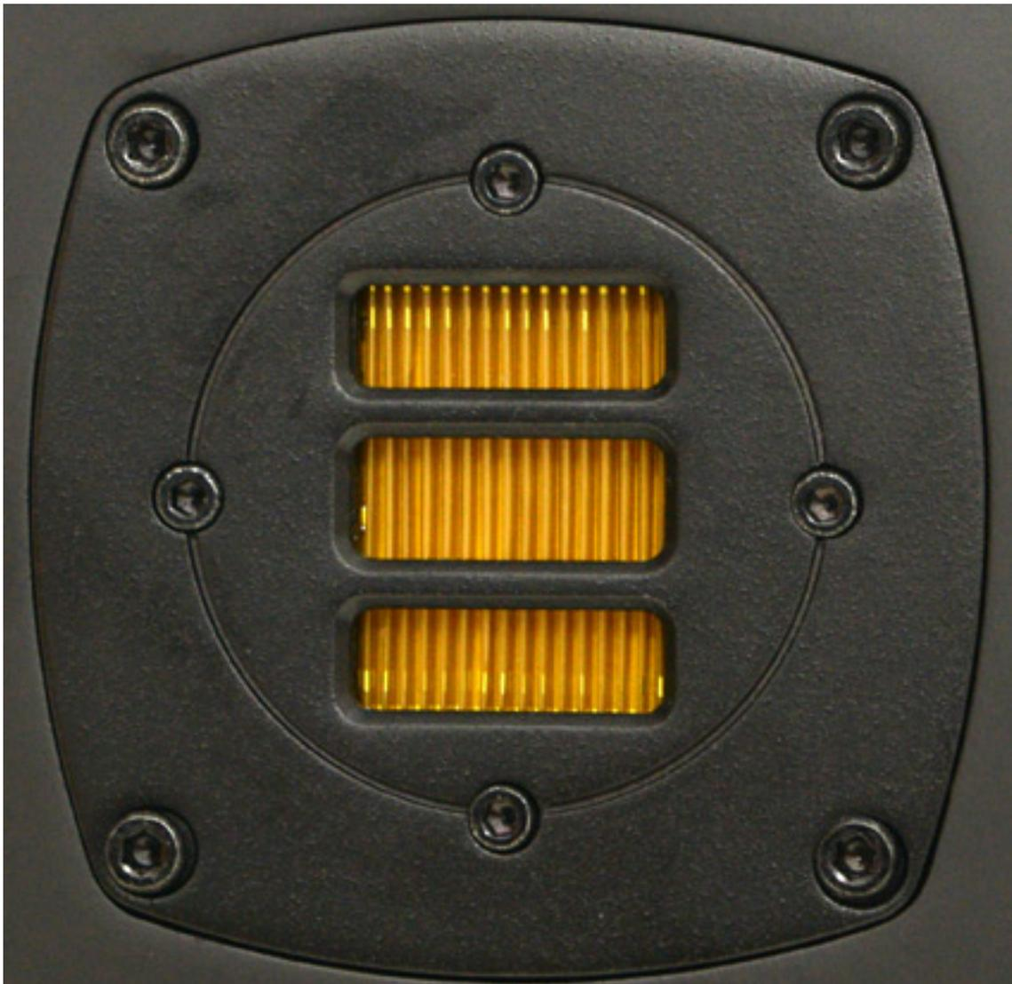
Der eingesetzten AMT RS2 Hochtontreiber ist ein Wandler nach dem sogenannten Air-Motion-Transformer-Prinzip, ursprünglich entwickelt von Oscar Heil. Die Bezeichnung RS2 dürfte hier wohl für den Entwickler Roland Stenz stehen.
