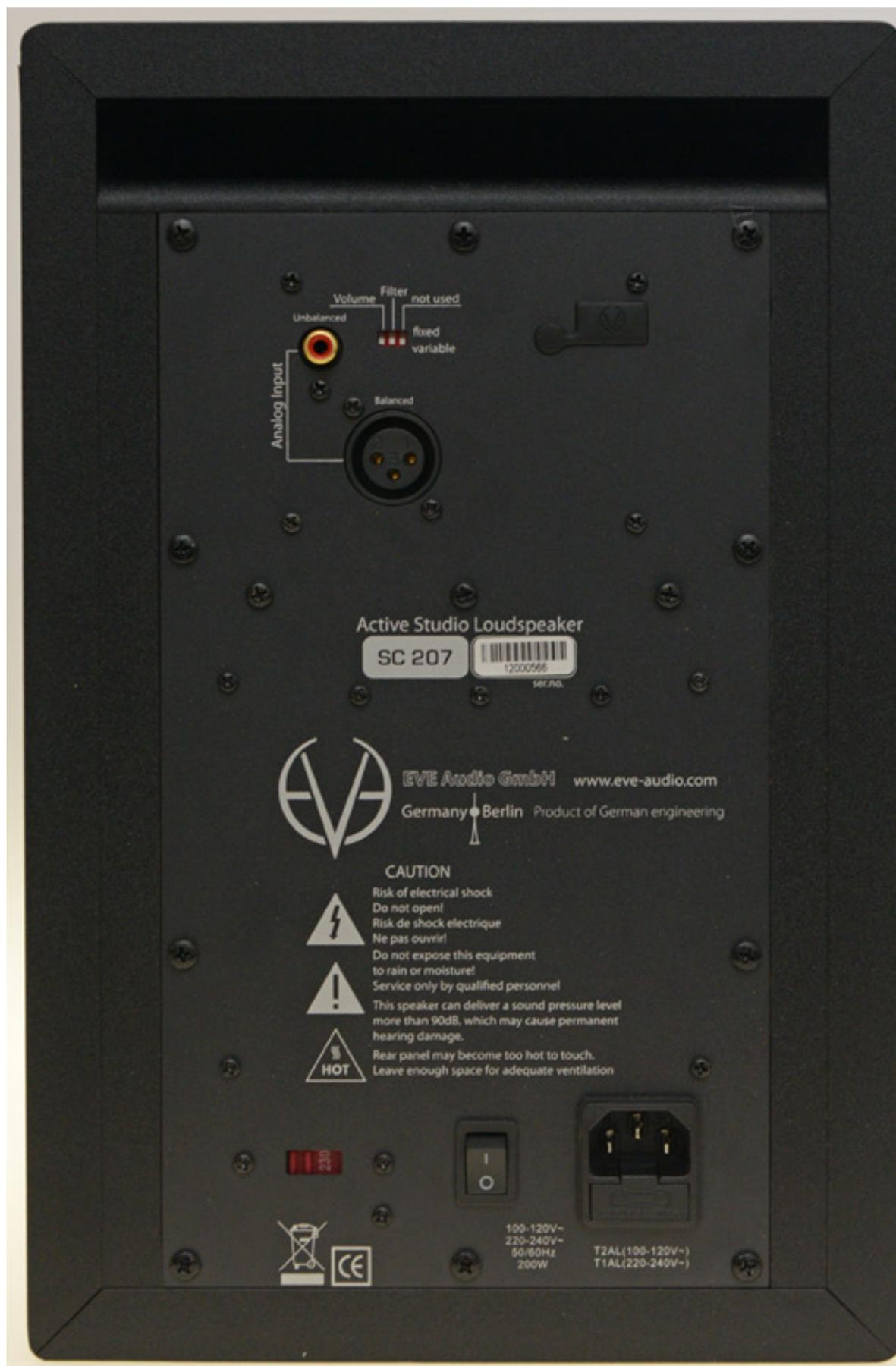
Neben Netzschalter, Netzbuchse und Netzspannungswahlschalter befinden sich im oberen Bereich eine Cinch-Buchse (10 kOhm Impedanz) für den Anschluss von unsymmetrischen Quellen und eine XLR-Buchse mit einem elektronisch symmetrierten Eingang (10 kOhm Impedanz). Der maximale Eingangsspegel darf maximal 8 dBu betragen. Wird der Eingang übersteuert blinkt auf der Front der LED-Ring.
