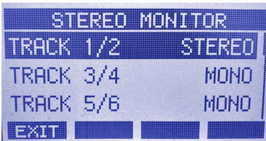
Wohin die USB-Kanäle 1/2 am Mischpult geroutet werden ist umschaltbar.
