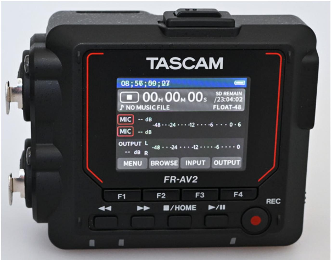
Nun zu der Bedienung über die Gerätefront. Verbaut ist hier ein Farb-Display (42 x 30 mm). Darunter sind vier Funktionstasten angeordnet, deren aktuelle Funktion auf dem Display angezeigt wird. Weiter gibt es vier Transport-Tasten für Paus/Play, Stopp und schneller Vor-/Rücklauf und eine Taste für den Aufnahmestart. Die Aufnahme wird mit der Stopp/Home-Taste abgeschlossen.
