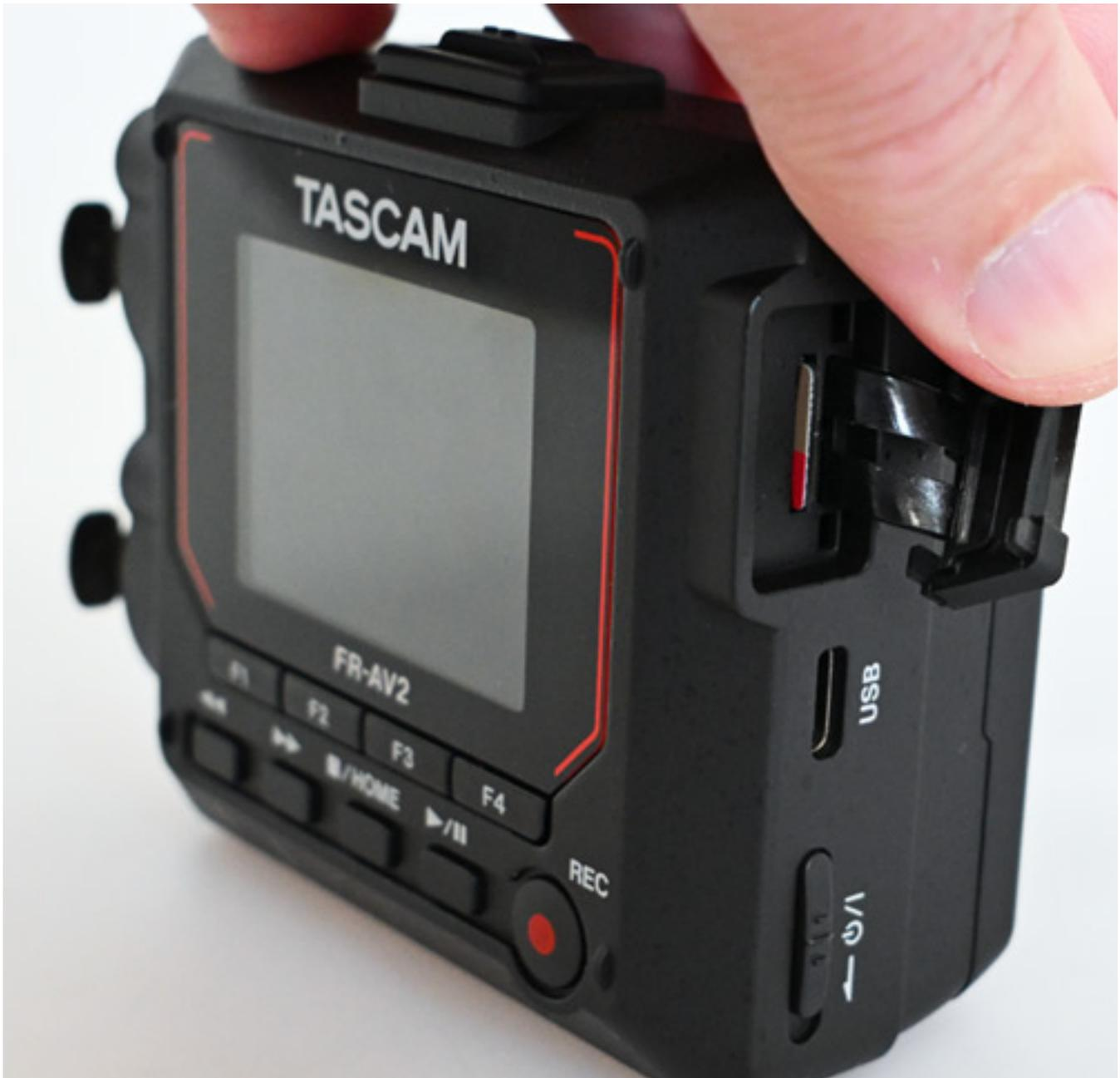
Auf der rechten Seite befindet sich der USB-2.0-Anschluss. Der ermöglicht übrigens nicht nur die zweikanalige Ausgabe sondern auch die digitale Zuführung von Audio via USB mit Abtastraten von 48 und 96 kHz und Wortbreiten von 24 Bit oder 32-Bit-Float. Unten ist der Ein/Ausschalter für den Recorder und hinter einer Gummiabdeckung befindet sich der Mikro-SD-Kartenschacht.
