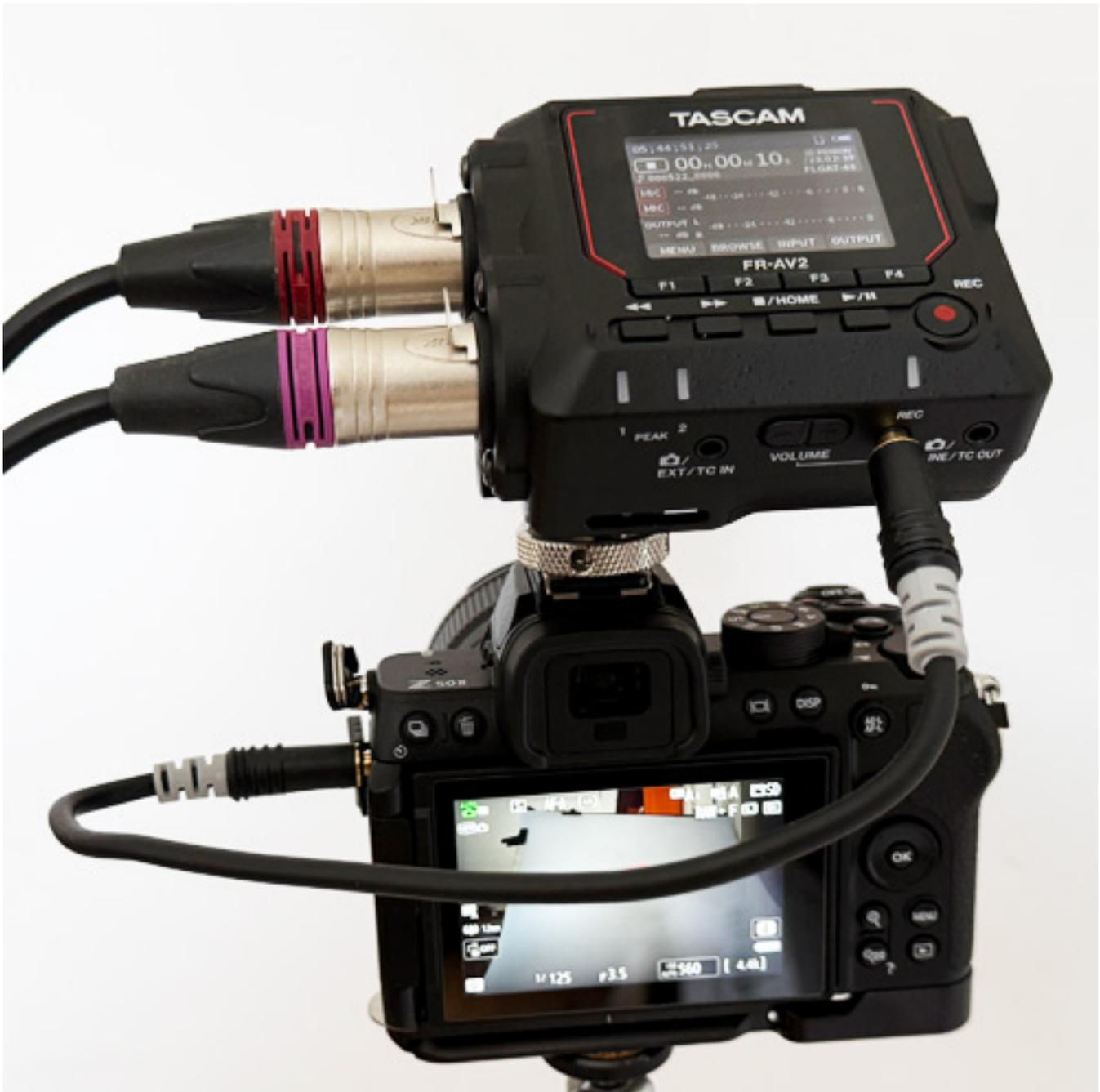
Bei Dauer-Aufnahmebetrieb mit Phantomspeisung und 32-Bit-Float/48 kHz reicht es mit normalen Alkali-Batterien immerhin zu ca. 4 1/2 Stunden und ohne Phantomspeisung sogar Doppel so lange. Beim Betrieb mit Lithium-Batterien erhöht sich die Laufzeit beim Dauerbetrieb um mehr als das Doppelte.
