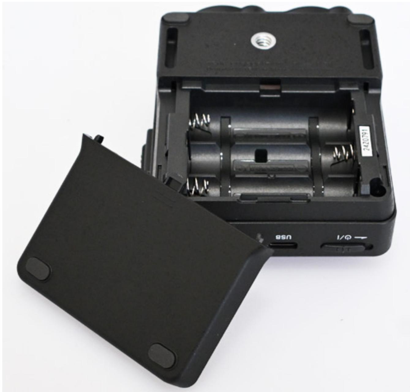
Betrieben wird der Recorder über drei AA-Batteriezellen (Alkali-Batterien, NiMH-Akkus oder Lithium-Batterien), die unter einer Abdeckung eingesetzt werden können. Auch ein Betrieb über USB-Spannungsversorgung ist möglich und ein externes Netzteil ist optional erhältlich (PS-P520U).
