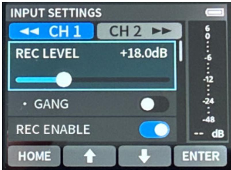
Über den INPUT-Dialog lässt sich der Aufnahmepegel anpassen und es ist auch eine Pegel-Verknüpfung der Kanäle möglich (GANG), man kann den Eingang, bzw. die Quelle auswählen (Mic, Line oder extern sowie USB), Stereo/Mono anwählen und die Phantomspeisung für jeden Kanal individuell aktivieren.
