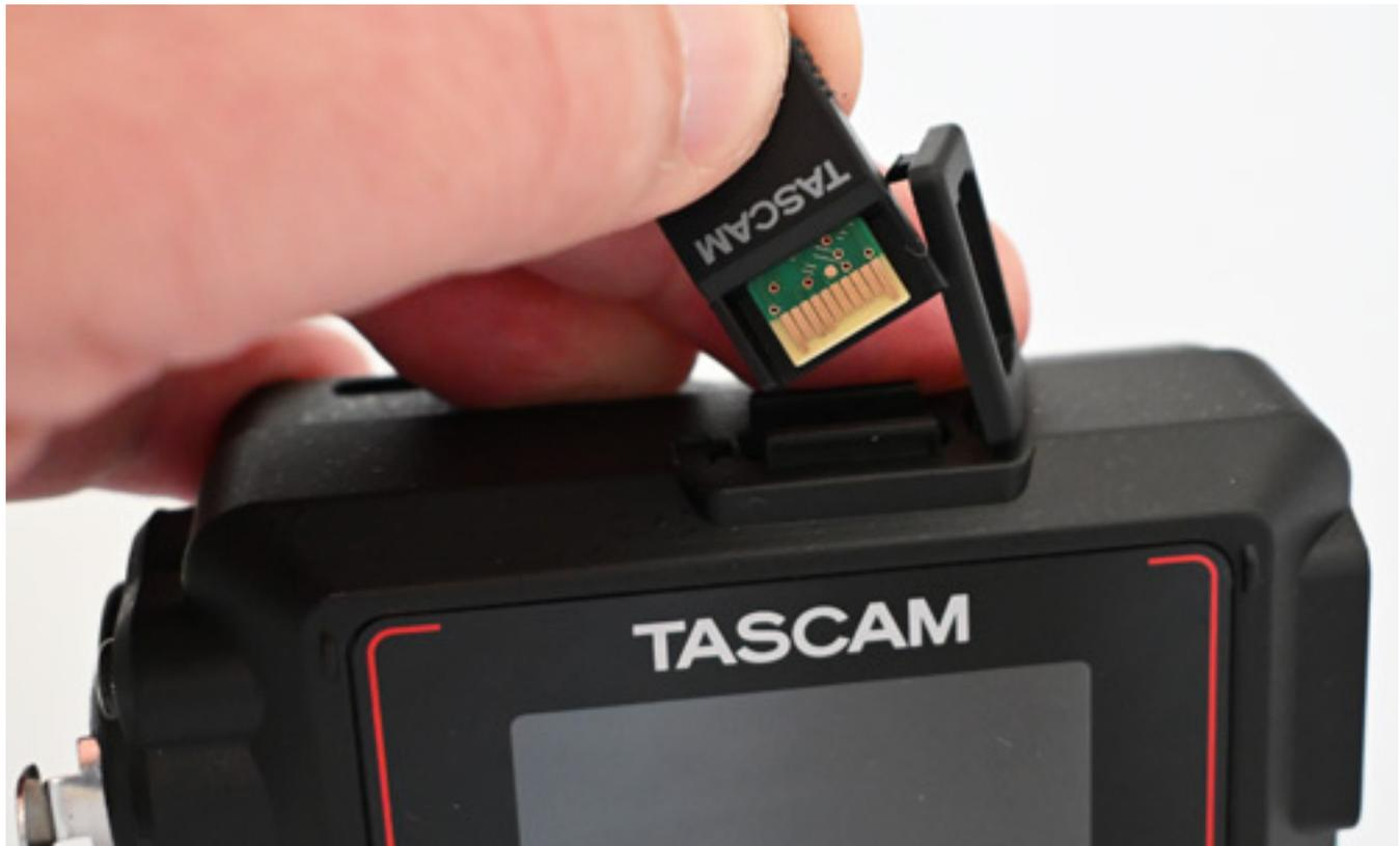
Ein ganz zentraler Punkt ist die Bluetooth-Fähigkeit des FR-AV2. Hier kommt ein anderes-Bluetooth-Modul zum Einsatz als beim DR-10L Pro - nämlich das Tascam AK-BT2, welches bei Bedarf optional dazugekauft werden muss. Der Adapter ermöglicht sowohl die Fernsteuerung als auch die Audioübertragung zu Monitorzwecken zu einem Bluetooth-fähigen Gerät.
