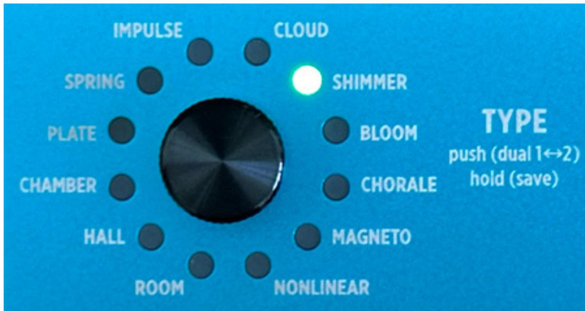
Gehen wir doch einmal die Algorithmen im Einzelnen durch. Schon der erste Algorithmus IMPULSE ist ganz neu und bietet ein Convolution Reverb, mit 22 anwählbaren, internen Impulsantworten mit bis zu zehn Sekunden Länge. Auch ein Laden von eigenen Impulsantworten ist möglich. Dazu später mehr.
