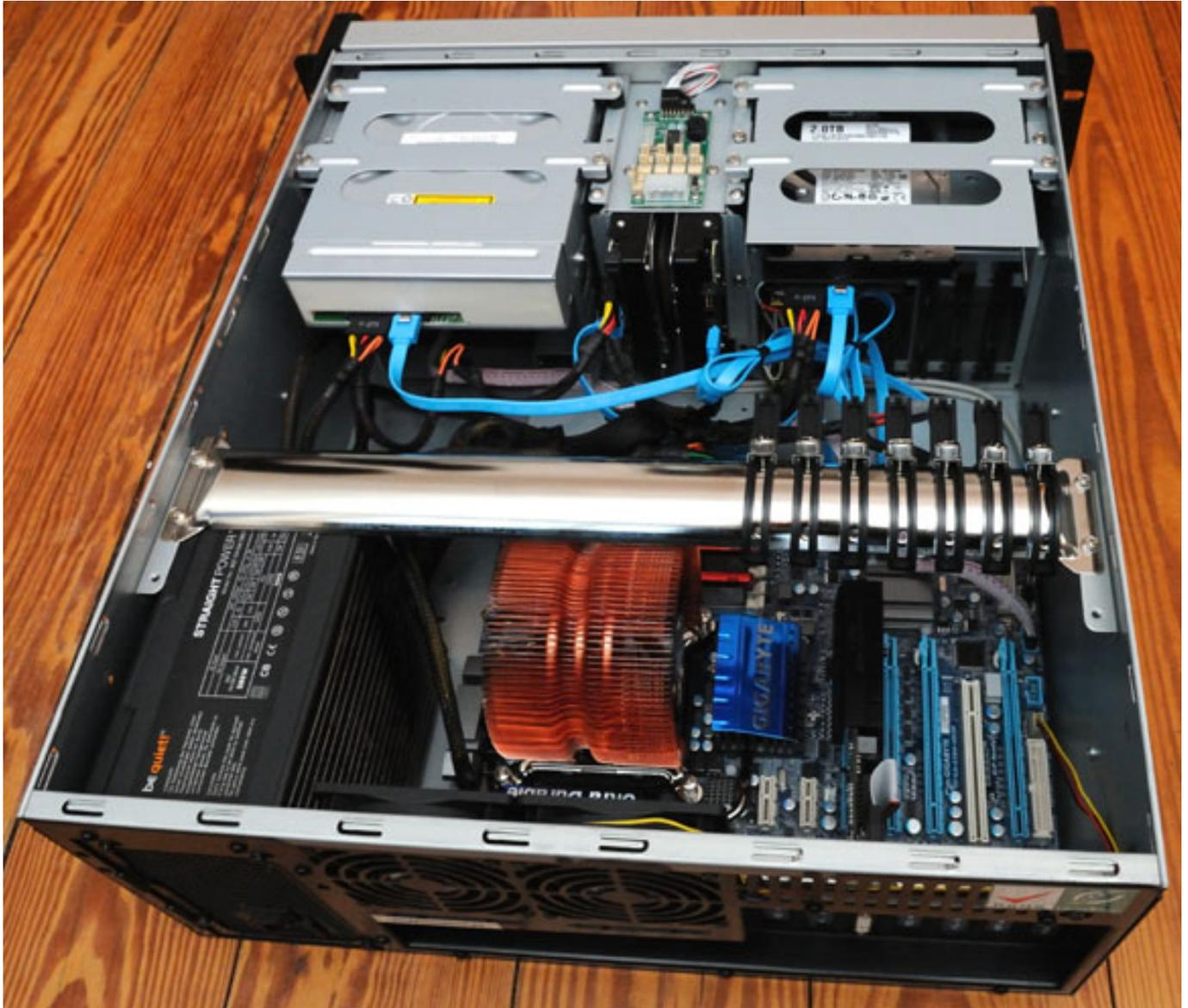
Das Motherboard von Gigabyte Technology - mit Intel Tylersbrug X58, bzw. Intel Nehalem Chipsatz - ist mit Schnittstellen üppig ausgestattet. So stehen On-Board folgende bereit: 1 x IDE, 10 x SATA/RAID, 8 x USB2.0, 2 x USB3.0, 2 x Firewire400, 2 x eSATA und Gigabit Ethernet LAN. Als Steckplätze sind ein PCI, zwei PCIe 2.0 x16, zwei PCIe 2.0 x8 und zwei, PCIe x1 vorhanden.
