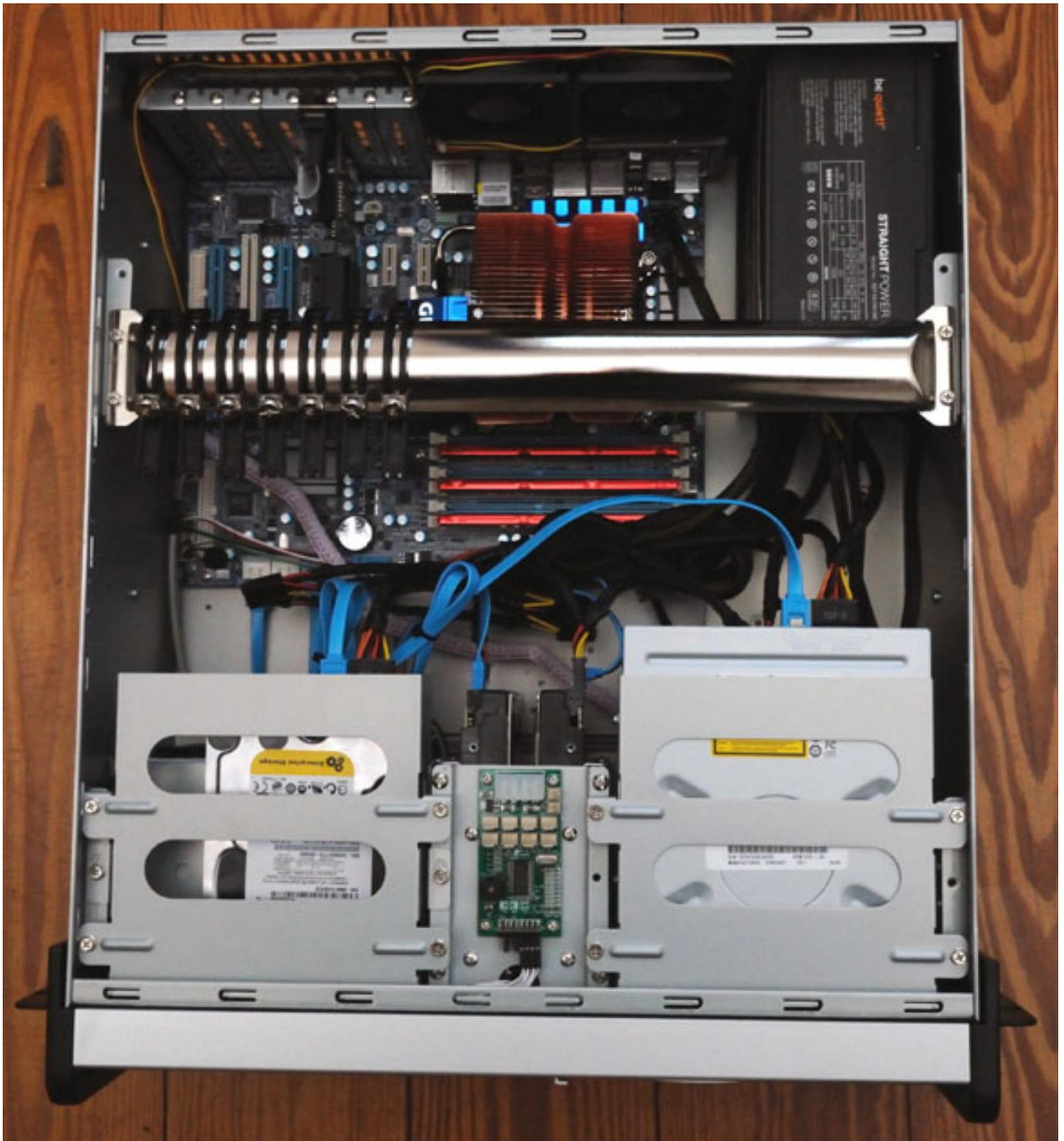
Der Rechner ist mit einem Quadcore I7-950 Prozessor (Bloomfield) mit 3,066 MHz Takt ausgestattet. Optional ist auch ein I7-960 mit einer Taktrate von 3,2 MHz, bzw. eine Hexacore-Variante, verfügbar. Wir haben hier die Standardvariante getestet. Der Rechner wird mit 6 GB RAM (Triple Channel DDR3 PC12800 mit Aluminiumkühlkörper) ausgeliefert. Optional lassen sich 12 oder 24 GB über den Shop vorkonfigurieren. Für die meisten Anwendungen reicht die Standardbestückung völlig aus.
