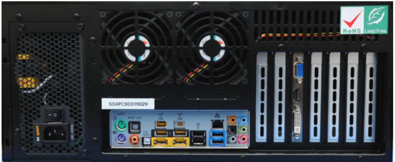
Alle Anschlüsse, bis auf zwei USB 2.0 an der Front, sind hinten zugänglich. Standardmäßig ist das On-Board-Audio von Steller-Online deaktiviert, da in unserer Branche ja immer ein externes oder zusätzliche internes Audiointerface eingesetzt wird.
