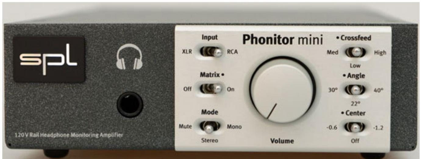
Die Frontplatte ist sehr aufgeräumt aber der Phonitor mini bietet deutlich mehr Funktionalitäten als der SPL Auditor. Der Pegelregler in der Mitte bietet bei Rechtsanschlag eine Verstärkung von 6 dB, die sich auch über DIP-Schalter nicht ändern lässt.
