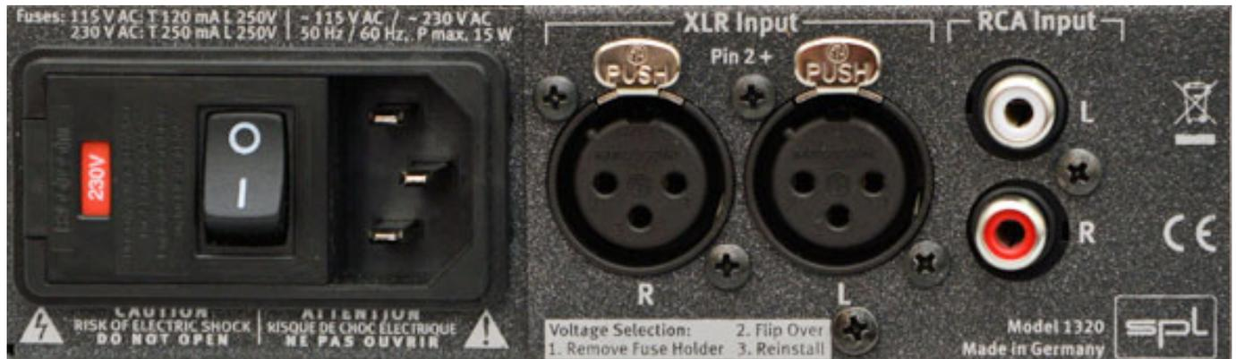
Ein Blick auf die Geräterückseite verrät uns, dass es hier zwei Eingänge gibt und zwar ein 2 \* XLR elektronisch symmetriert und einen unsymmetrischen Cinch/RCA-Eingang. Auf einen extra Ausgang hat man beim Phonitor mini ganz verzichtet. Es gibt hier lediglich den 6,3-mm-Klinkenausgang für den Anschluss des Kopfhörers.
