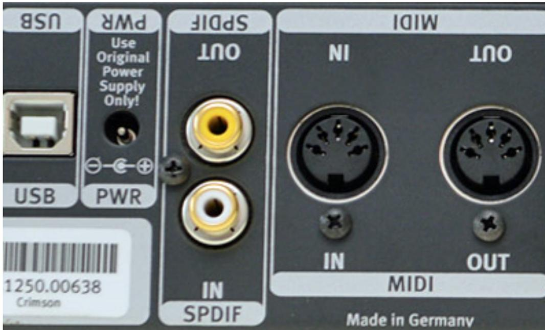
Ganz links sind auf der Rückseite befinden sich neben dem USB 2.0-Anschluss und dem Anschluss für das externe, mitgelieferte Steckernetzteil, ein SPDIF-Ein- und Ausgang sowie auch eine MIDI-Schnittstelle (5-pol. DIN, Ein- und Ausgang).
