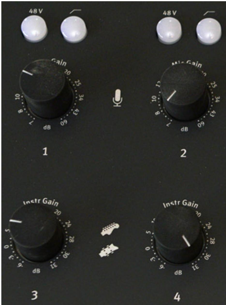
Auf die beiden Mikrofoneingänge lässt sich getrennt 48-Volt-Phantomspeisung aufschalten. Weiter kann, ebenfalls individuell, ein 75-Hz-Hochpass (Filtersteilheit 6 dB/Oktave) zugeschaltet werden um Trittschall oder andere tieffrequente Störsignale zu unterdrücken. Der einstellbare Verstärkungsbereich ist mit 7 ... 60 dB mehr als ausreichend. Unter den Trimmreglern für die Mikrofoneingänge befinden sich die beiden Regler für die beiden Instrumenteneingänge.
