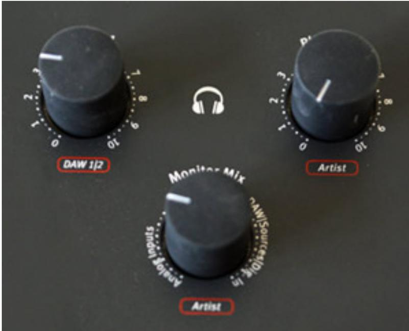
Auf der rechten Seite ist einmal der große Regler für die Einstellung des Monitorabhörpegels und darüber zwei Regler für die beiden Kopfhörerpegel und einen Regler mit dem sich das Pegelverhältnis im Monitoring zwischen analogen Eingangsquellen und DAW/Sources/Digi In einstellen lässt.
