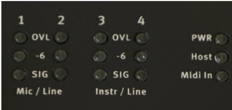
In der Mitte befindet sich oben ein Indikatorbereich (s. Abb. oben) für die Aussteuerung mit je drei LEDs für -42 dB, - 6dB und Overload der vier analogen, regelbaren Eingangskanäle sowie Statusanzeigen für Spannungsversorgung, USB-Host und MIDI-Eingangssignaldetektion.
