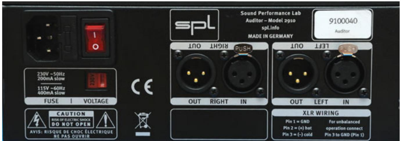
Der Auditor besitzt zwei elektrisch symmetrierte, analoge Eingänge, die als XLR-Buchsen ausgeführt sind. Sehr praktisch auch, dass es auch zwei durchgeschliffene Ausgänge gibt, die z. B. zur Speisung eines Verstärkers oder aktiver Boxen dienen können. Auf Klinken- oder gar Chinch-Eingangsbuchsen hat man verzichtet. Bei einem Produkt mit dem speziellen Anwenderprofil sicherlich auch kein Problem. Auf der Front befindet sich eine 6,3-mm-Stereoklinke für den Anschluss des Kopfhörers.
