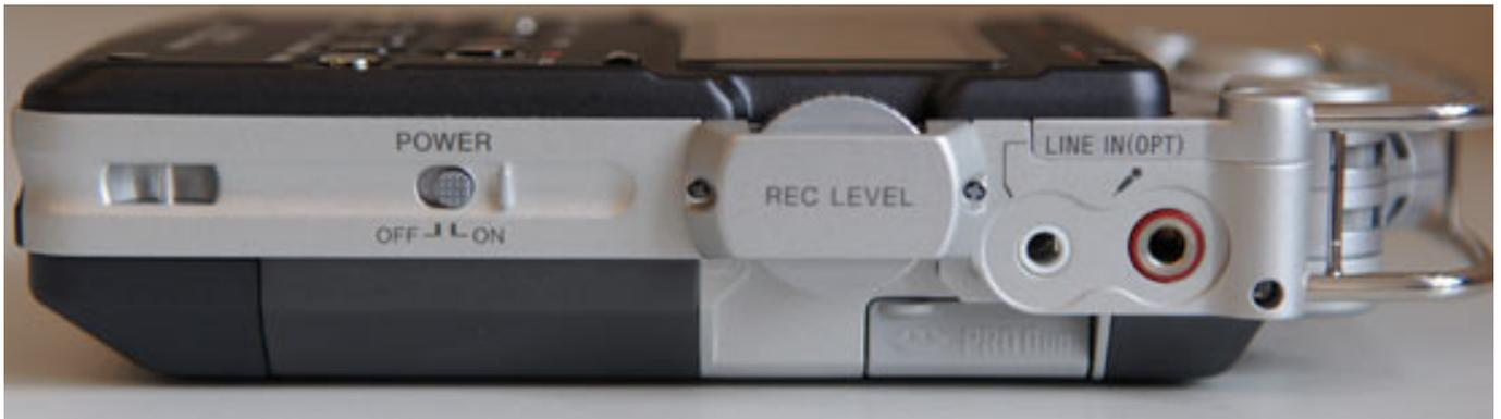
Auf der linken Geräteseite befinden sich Kombi-Line-Ausgang (elektrisch/optisch) sowie ein Kopfhörerausgang (3,5-mm-Klinke). Weiter ist hier der Regler für die Wiedergabepegel) sowie Miniaturschalter für die Umschaltung Line/Mikro und eine 20-dB-Dämpfung für den Mikrofoneingangspegel vorhanden.
