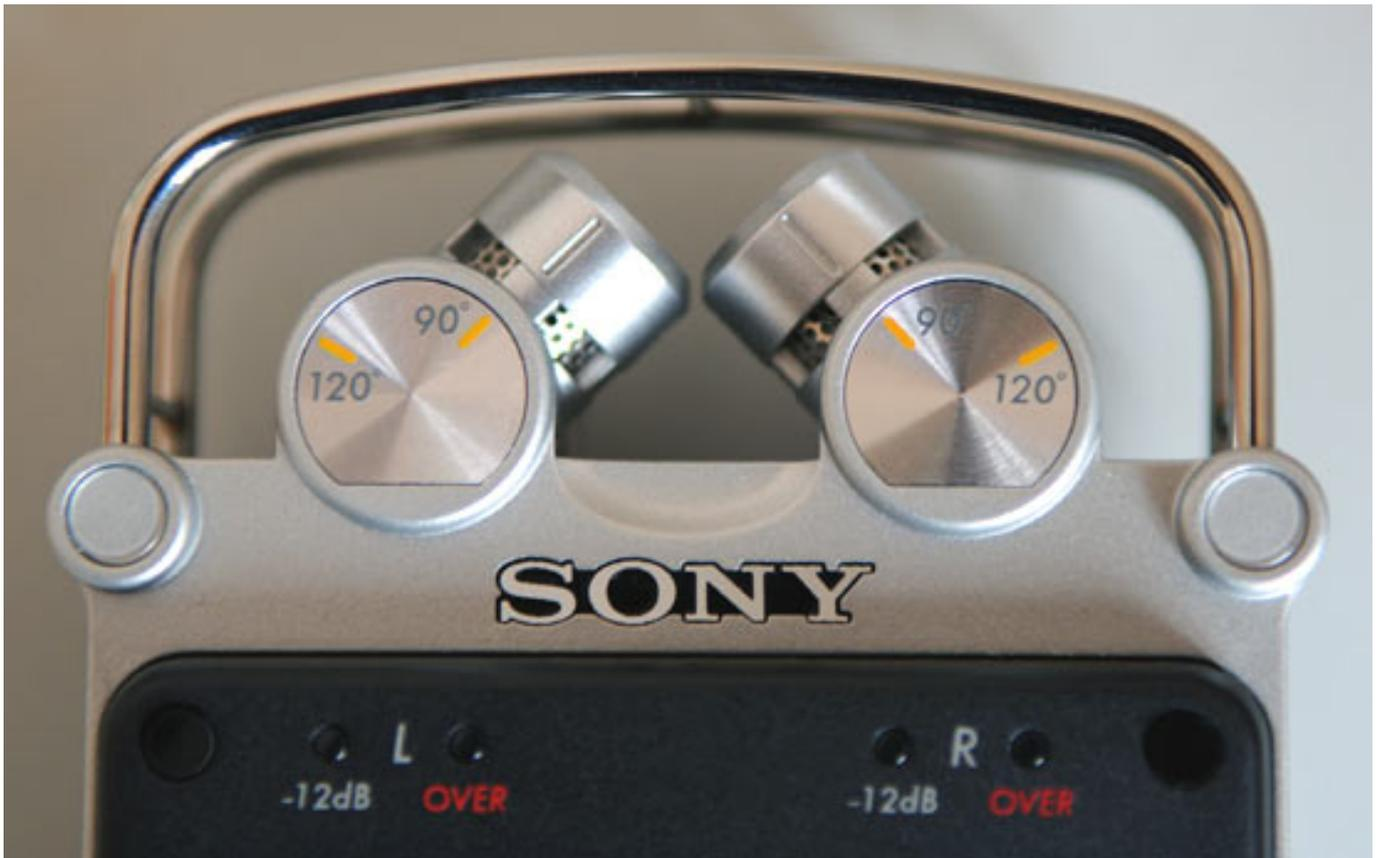
Die beiden, über einen robusten Bügel geschützten, integrierten Mikrofone sind Elektret-Kondensatormikrofone, die sich in drei Positionen verstellen lassen und zwar 90 Grad (XY-Anordnung), 120 Grad, bzw. 0 Grad (klein AB-Anordnung mit 33 mm Abstand). Für Außenaufnahmen gibt es noch einen aufsteckbaren Windschutz aus Fell, der auch den Anforderungen im Reportagebereich stand hält. Es scheinen nicht die gleichen Mikrofone wie beim PCM-D1 zu sein aber die Mikrofone sind auch sehr hochwertig.
