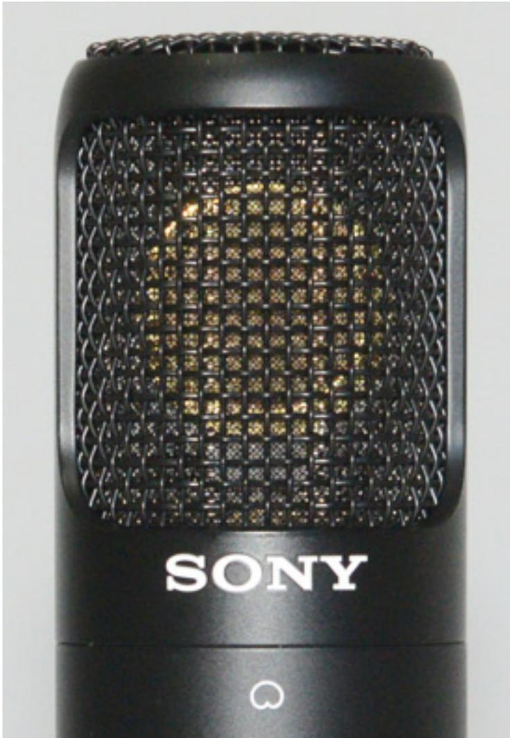
Mit dem Dämpfungsschalter lässt sich das Signal um 10 dB absenken. Über Einsatzfrequenz und Filtersteilheit des Low Cut Filters sind keine Angaben zu finden. Der Frequenzgang ist aus der beiliegenden Bedienungsanleitung ersichtlich. Hier ist eine leichte Anhebung um die 100 Hz zu erkennen, ab 5 kHz werden die Höhen deutlich angehoben. Neben der schon erwähnten Mikrofonspinne und der Bedienungsanleitung ist noch ein Softcase zum Schutz des Mikros im Lieferumfang enthalten.
